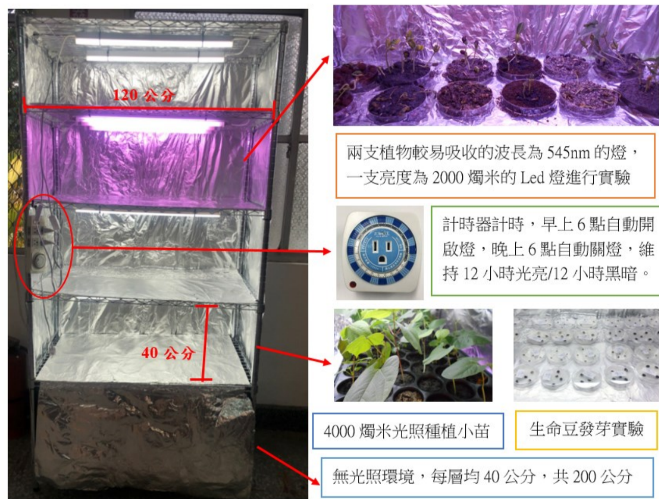
圖 3-2-1:自製植物培養箱培養生命豆小苗及種子發芽實驗說明圖
