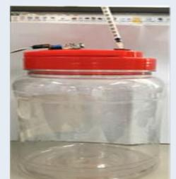
自製酒測罐模擬酒測情形，維持37°C，將酒測標準值0.15、0.25mg/L的酒精蒸氣加入以1mL水搗碎的神秘果反應。
