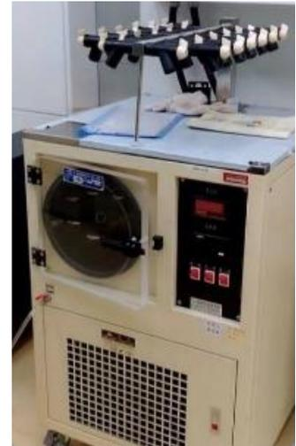
圖三 冷凍真空乾燥機
