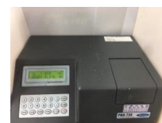
步驟 6-5 以波長 660nm 分 光光度計測量吸 收度
