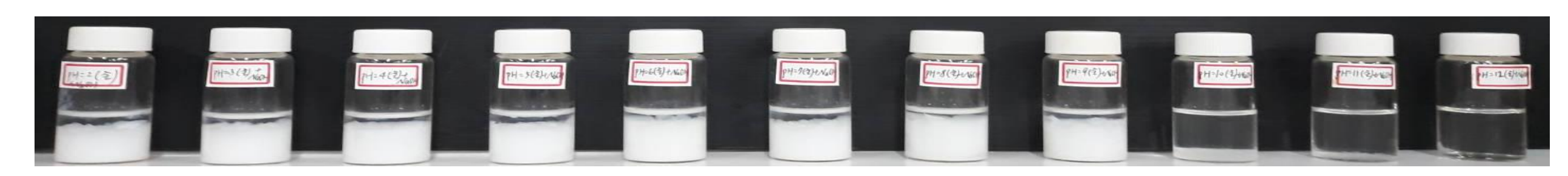
【圖】檸檬酸鈦水溶液在不同pH的沉澱結果
