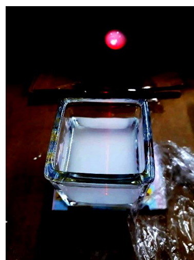
【圖】雷射穿透溶液到達照度計照度 100、200、300 LUX 所需時間(秒)
