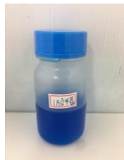
步驟 6-2 以最大吸收波長 (660nm)調製 1.000A 亞甲藍水 溶液
