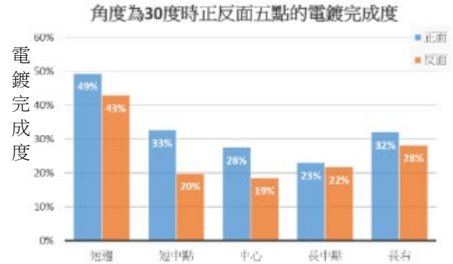
圖 20.b: 30 度時正面各點的電鍍完成度
