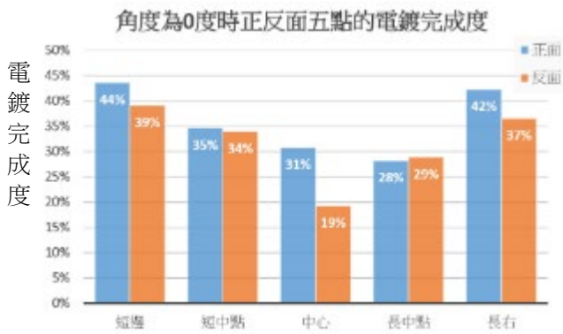
圖 20.a: 0 度時正反面各點的電鍍完成度
