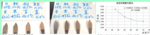
圖 29. 電鍍液加熱後進行電鍍 圖 30. 進行電鍍實驗
