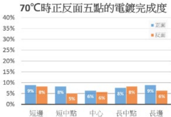
圖 33a.70°C 時的正反面各點的電鍍完成度圖
