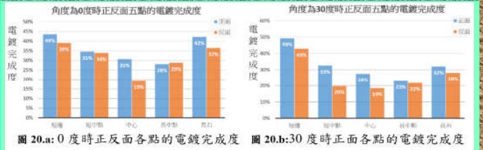
圖 20.a: 0 度時正反面各點的電鍍完成度 圖 20.b: 30 度時正面各點的電鍍完成度
