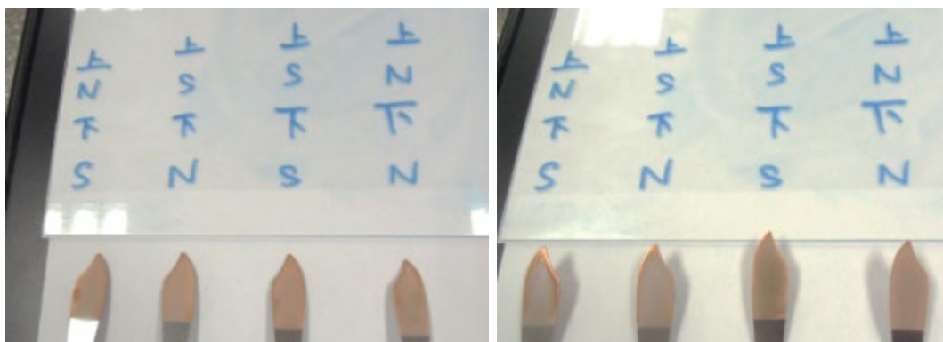
圖 23. 不同電鍍方向的電鍍結果，正面(左)與反面(右)
