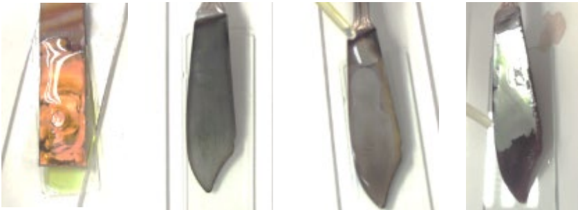
圖 35.氧化銅溶於濃鹽酸，電鍍黑色物質不溶於濃鹽酸，易溶於濃硝酸
