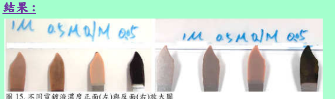
圖 15. 不同電鍍液濃度正面(左)與反面(右)放大圖
