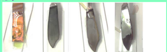
圖 35. 氧化銅溶於濃鹽酸，電鍍黑色物質不溶於濃鹽酸，易溶於濃硝酸
