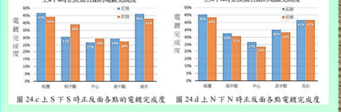
圖 24.c 上 S 下 S 時正反面各點的電鍍完成度 圖 24.d 上 N 下 N 時正反面各點電鍍完成度
