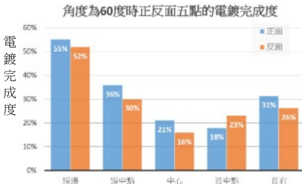
圖 20.c: 60 度時正反面各點的電鍍完成度
