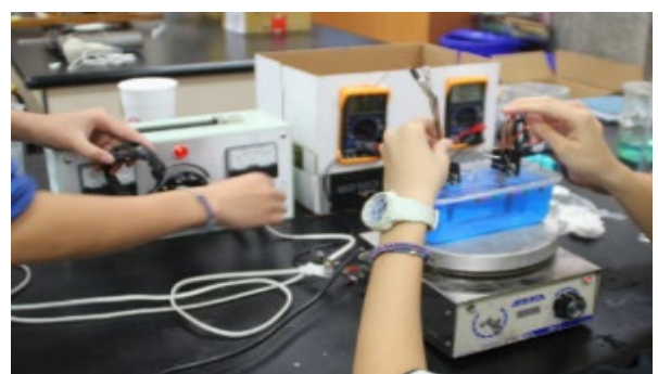
圖 25. 擾動電鍍液的實驗裝置
