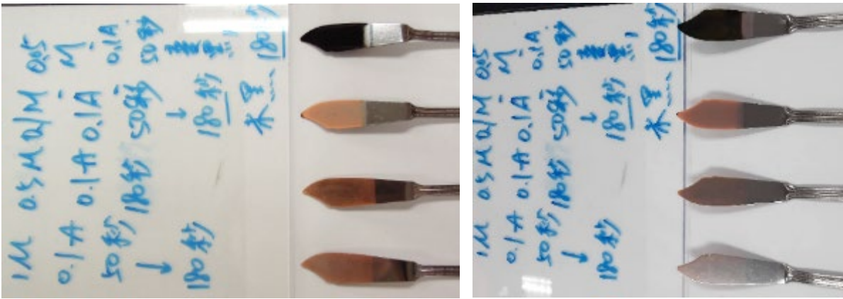
圖 14.不同濃度的硫酸銅電鍍液的電鍍結果
