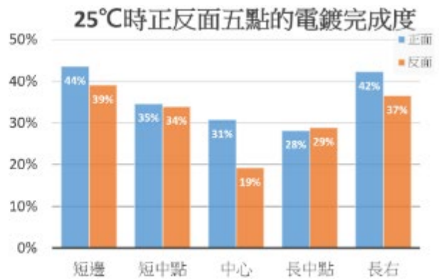
圖 33d.25°C 時的正反面各點的電鍍完成度
