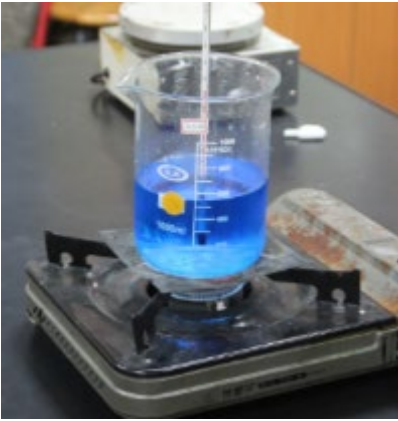
圖 29.電鍍液加熱後進行電鍍 圖 30.進行電鍍實驗
