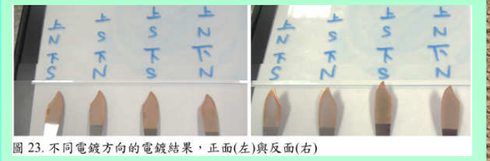
圖 23. 不同電鍍方向的電鍍結果, 正面(左)與反面(右)
