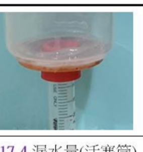
圖 17-4 漏水量(活塞筒)
