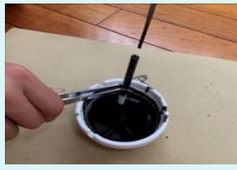
圖 7-2 注入墨水觀察滴下狀況
