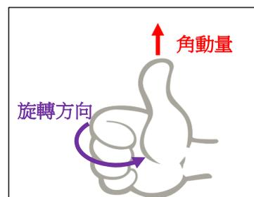
因此，我們實驗的旋翼球體，只要轉動起來，便能產生轉動慣性--角動量。但翼片的質量很小，對不同球體的轉動慣量影響不大，因此計算角動量 $L = I \times \omega$ 時，僅以角速：rev/s 進行比較，轉速愈快則角動量愈大。
