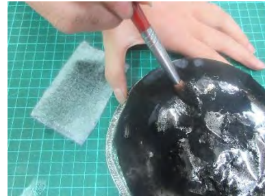
5. 將自製的奈米碳均勻的塗在濾材
