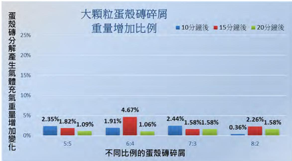
圖 5-2-7 大顆粒蛋殼磚碎屑醋酸分解氣球實驗數據圖
