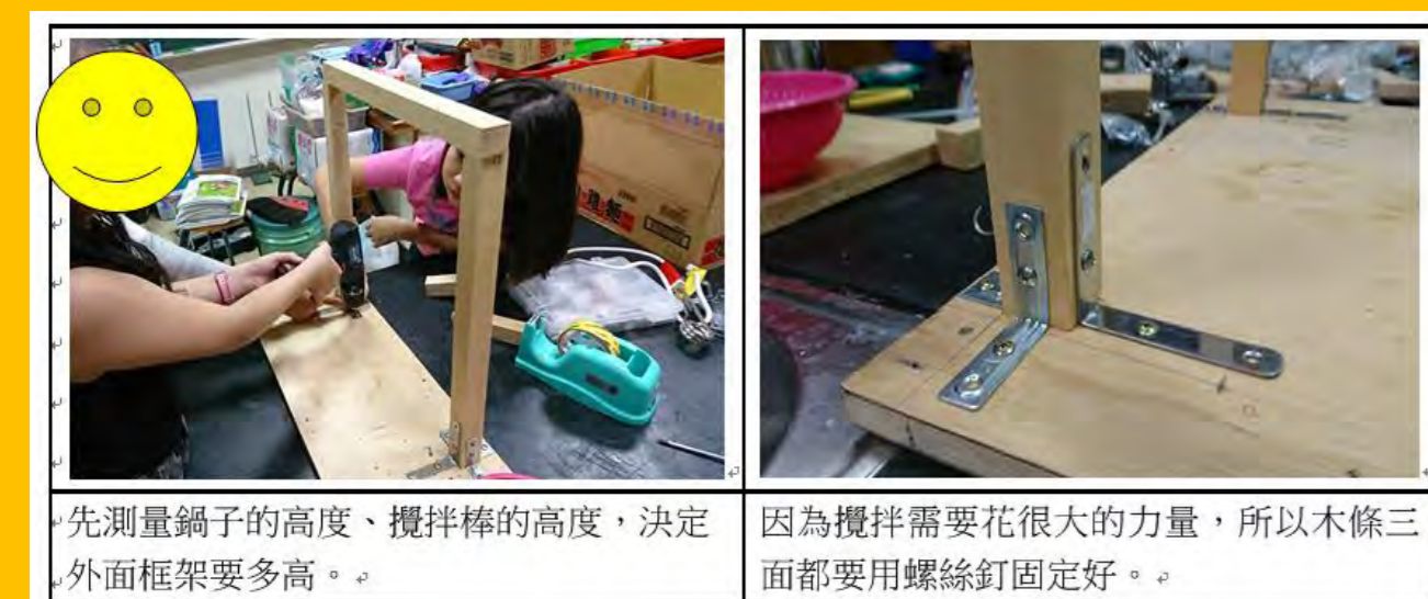
因為攪拌需要很大的力量，書局的高速小馬達手指一捏就停下來了，力量很弱，所以我們用強力馬達。剛好下面有螺絲孔，所以我們用螺絲釘鎖在鐵片上，再用螺絲釘鎖在木條上，這樣才夠堅固。
