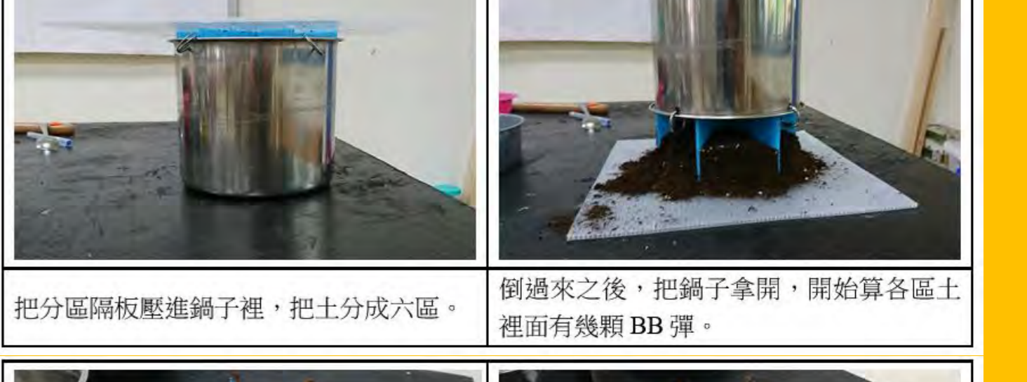
照鍋子開口的大小平均分成六等份。用熱熔膠黏上分區的隔板，隔板高度和鍋子深度要一樣，比較好壓進土中。
