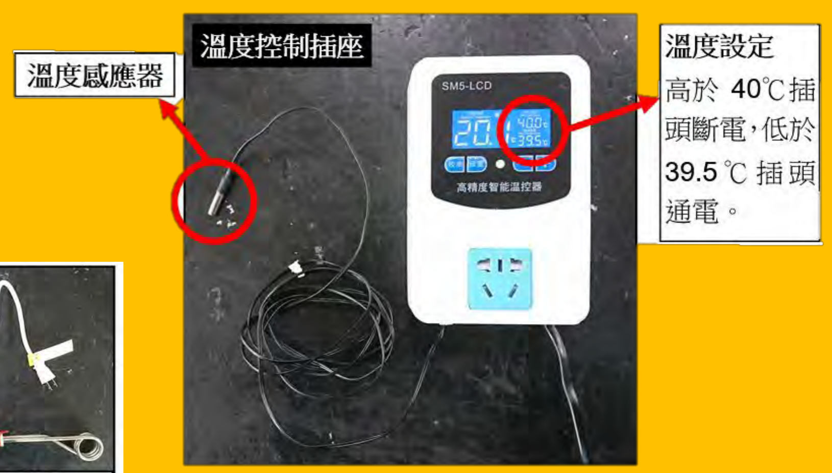
電湯匙沒有開關，直接用插頭來決定是否通電加熱。
