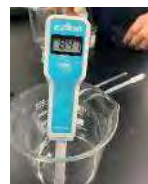
圖 4-3-14 用小蘇打粉調出 P H 值約 8.5 的 250ml 的水溶液兩杯
