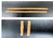
圖 4-3-17 製作四支長度相同，粗細顆粒不同條件的麥麩吸管。
