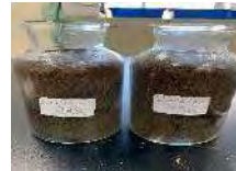
圖 4-3-19 裝相同高度的腐植土進入廣口瓶內，瓶外貼標籤紙。
