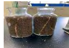
圖 4-3-20 把吸管靠在透明瓶身上，固定時間觀察吸管的變化。
