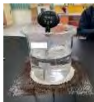
圖 4-3-9 用酒精燈加熱 50ml 一般飲用水達 60°C 左右的溫度
