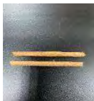
圖 4-3-8 分別製作細顆粒麥麩吸管與淋上蜂蠟的細顆粒麥麩吸管二支
