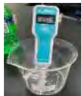
圖 4-3-13 用檸檬酸調製出 P H 值約 2.0 的 250ml 的水溶液兩杯
