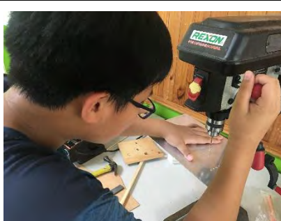
圖 70 利用鑽孔機鑽孔洞
