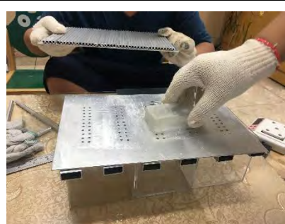
圖 71 110 孔洞排水導流板
