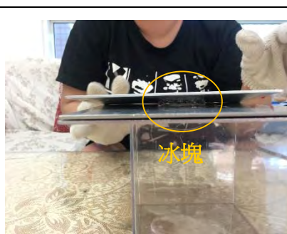
圖 24 冰塊上下層皆能與鋁板接觸。
