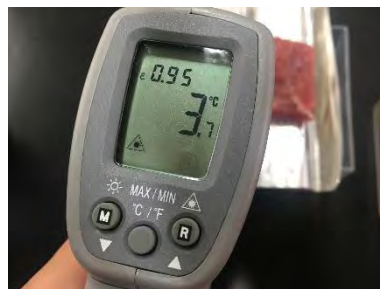
圖 19 解凍肉塊表面溫度範圍在 3.5°C ~3.7°C
