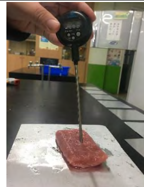
圖 20 解凍肉塊中心溫度範圍在 2.4°C ~2.7°C
