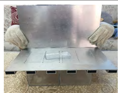
圖 72 66 孔洞排水導流板
