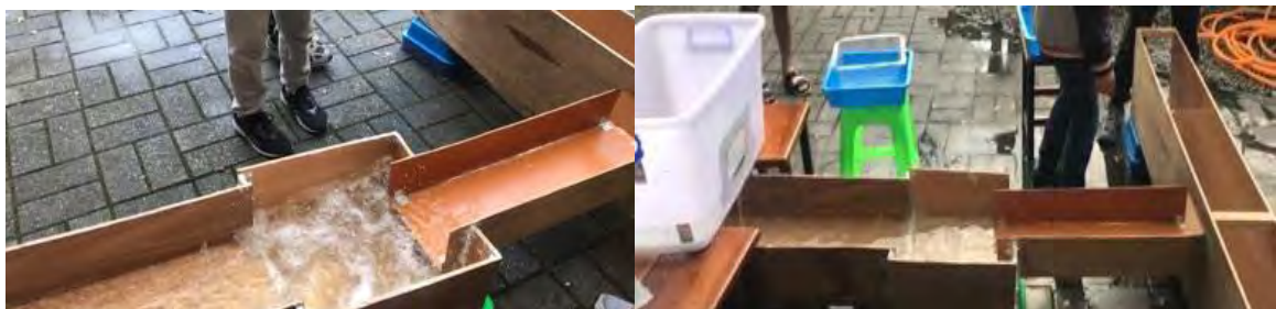
[圖 34] 水流出後有大部分會先在校內水溝及陰井處積到一定高度才流向聯外排溝
