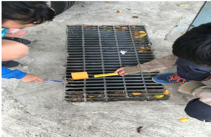
[圖 15]探討水溝蓋種類的摩擦力之實驗裝置
