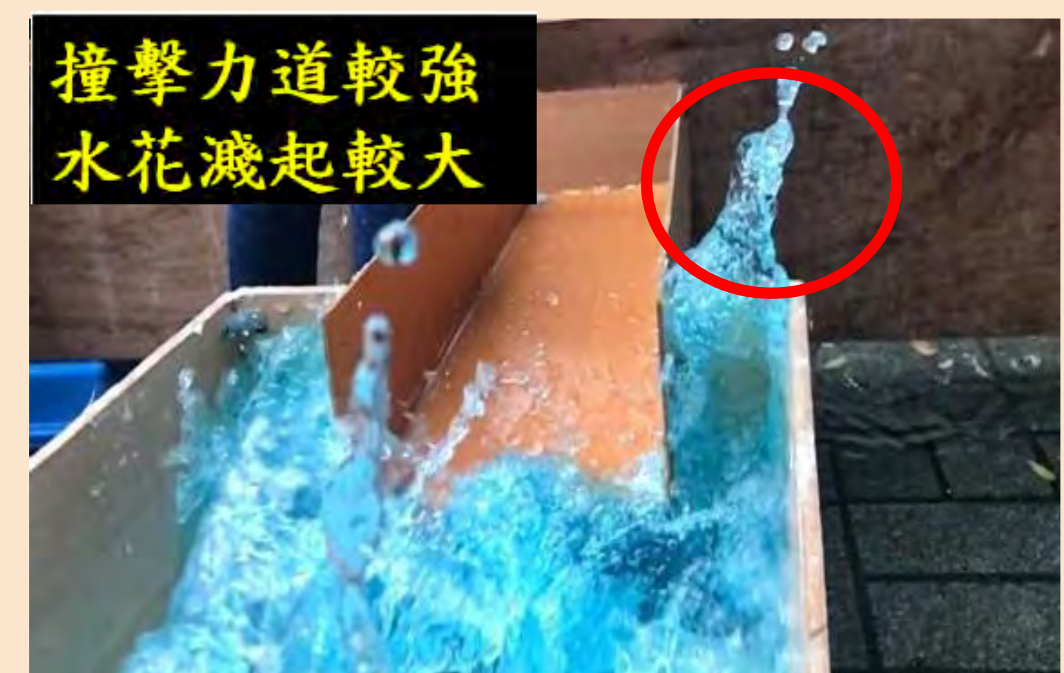
[圖30]洩水坡度0.028陰井處
