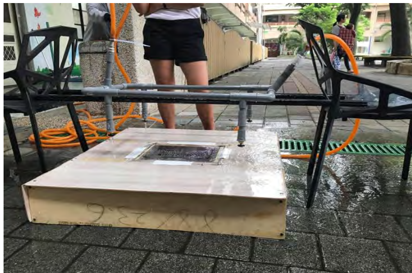
[圖 14] 探討水溝蓋種類對集水效果之實驗裝置
