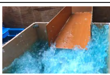
[圖 32-2]實驗二洩水坡度 0.014 陰井處慢動作截圖 時間軸 2
