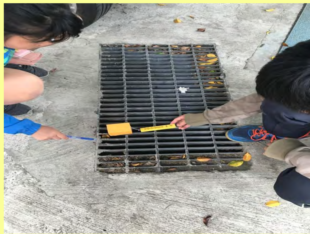
[圖13]實驗四、五水溝蓋摩擦力實驗示意圖
