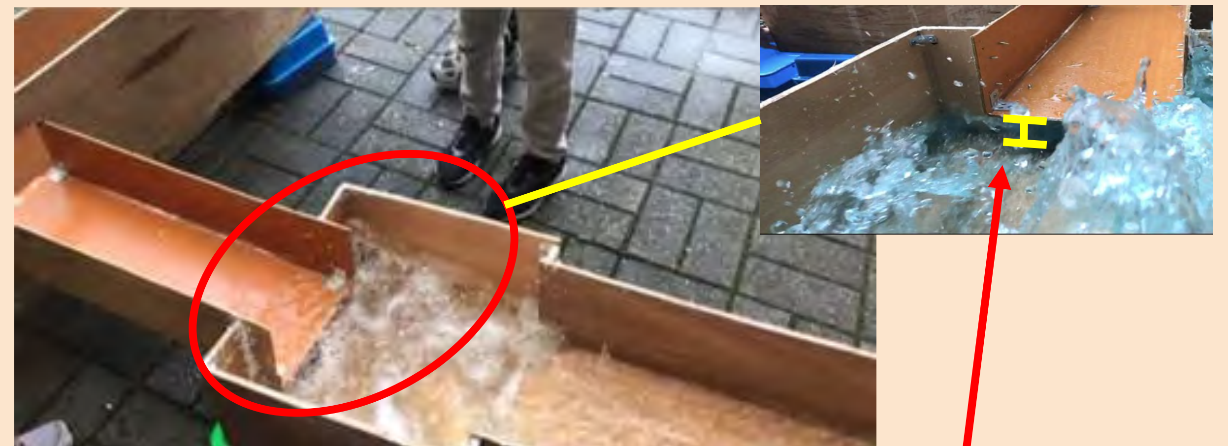
[圖31]陰井和聯外排溝處有高低差，水量要淹到一定程度才能排水
