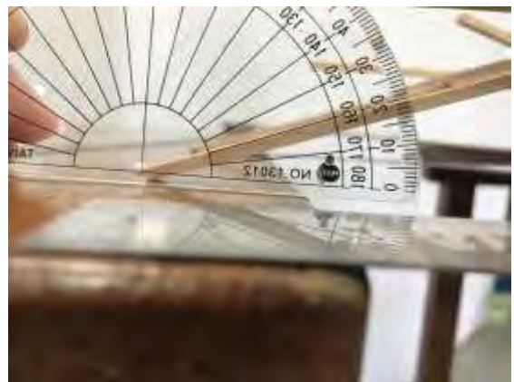
量測接地角度
