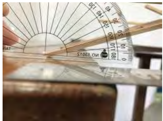
量測接地角度
