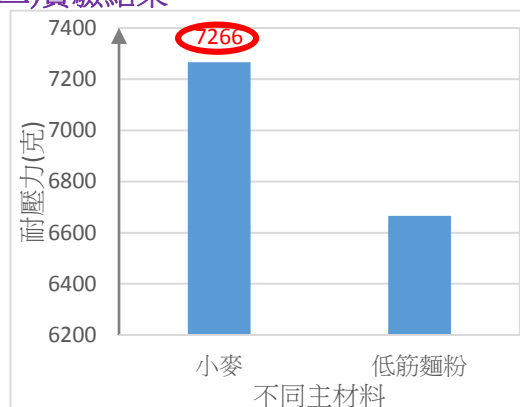
圖 5 不同主材料 吸管中間耐壓力
