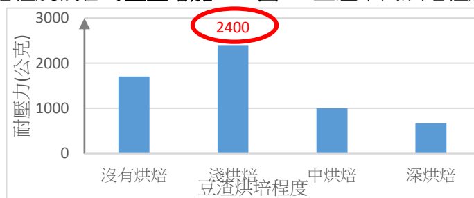
圖 15 豆渣不同烘焙程度吸管的耐壓力
