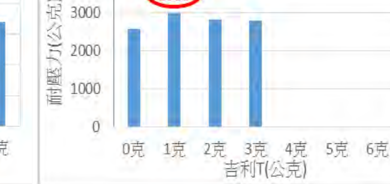
圖22 不同比例吉利T製成吸管的耐壓力
