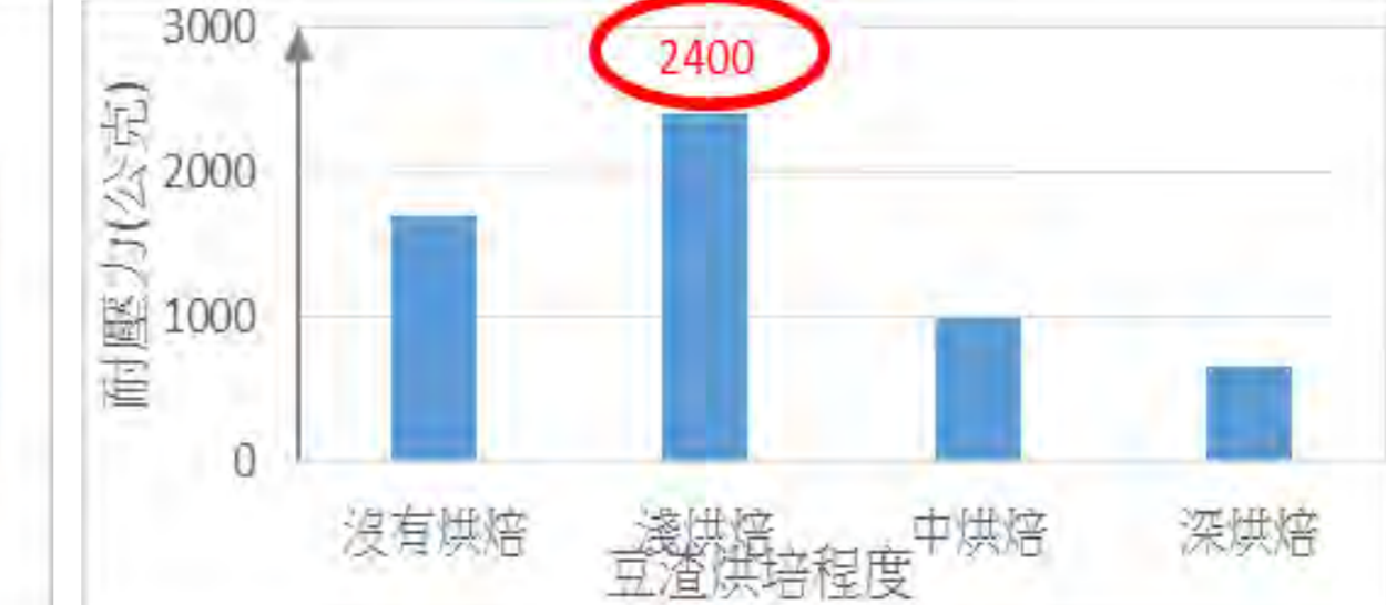
圖15 豆渣不同烘焙程度吸管的耐壓力
