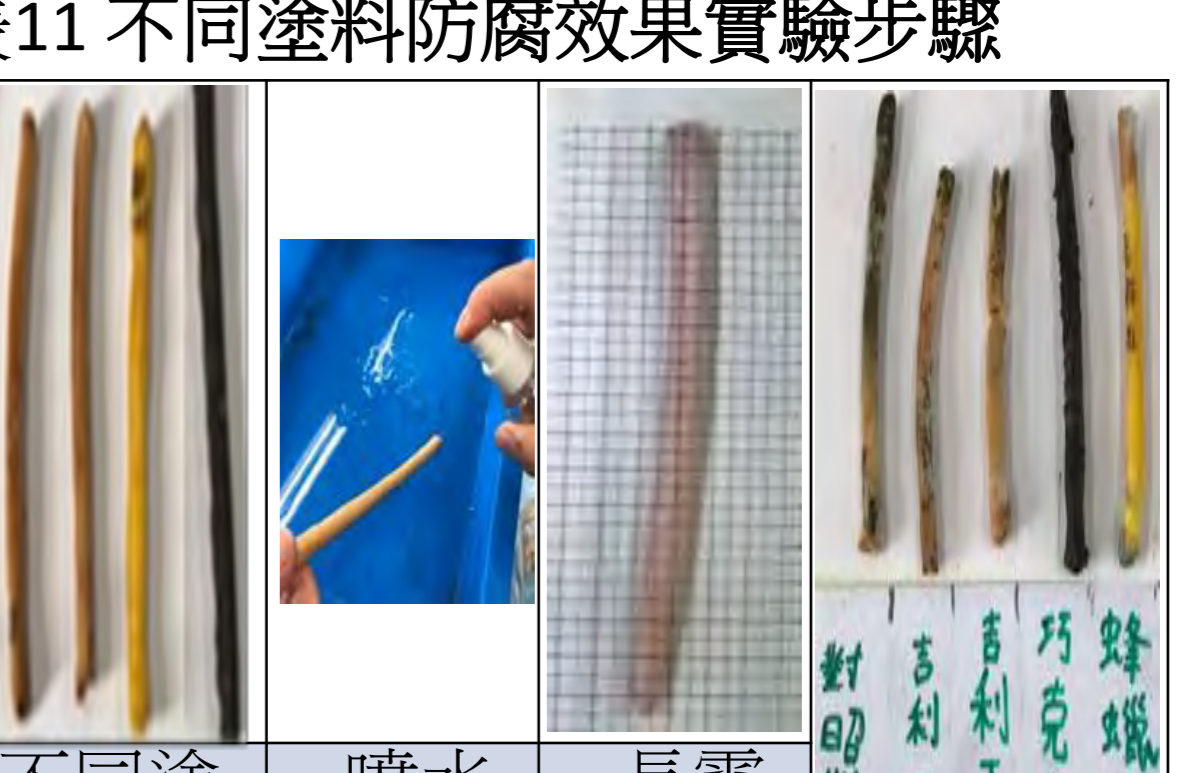
不同塗料吸管 噴水 5c.c 長霉面積
