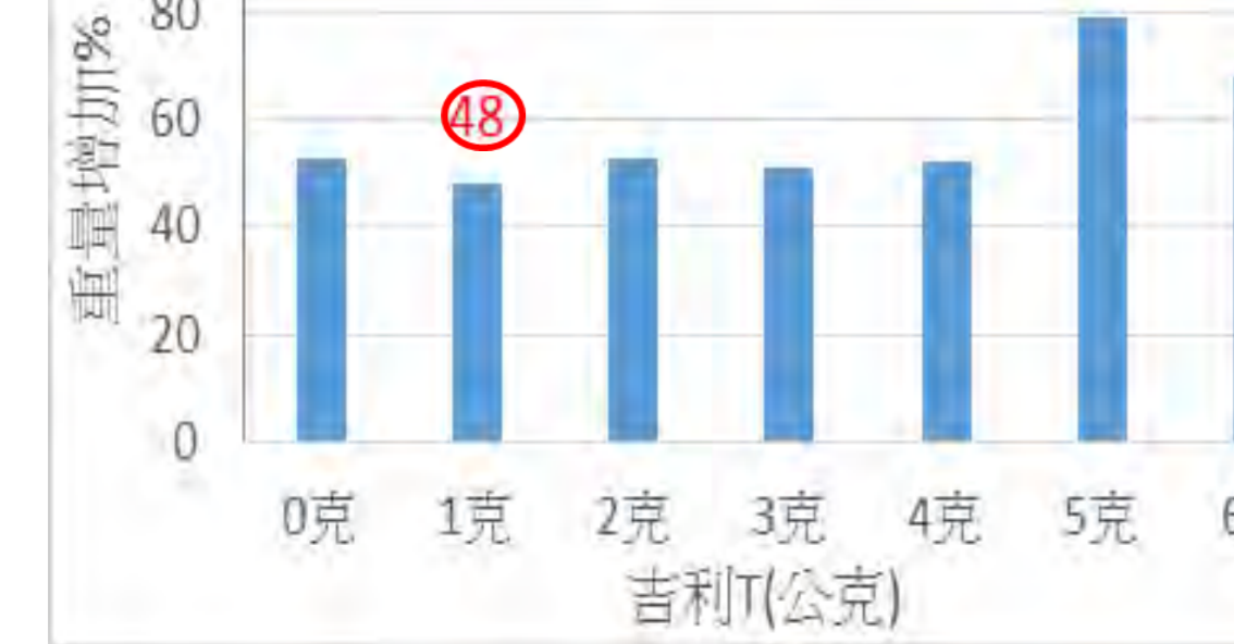
圖21 不同比例吉利T製成吸管重量增加
