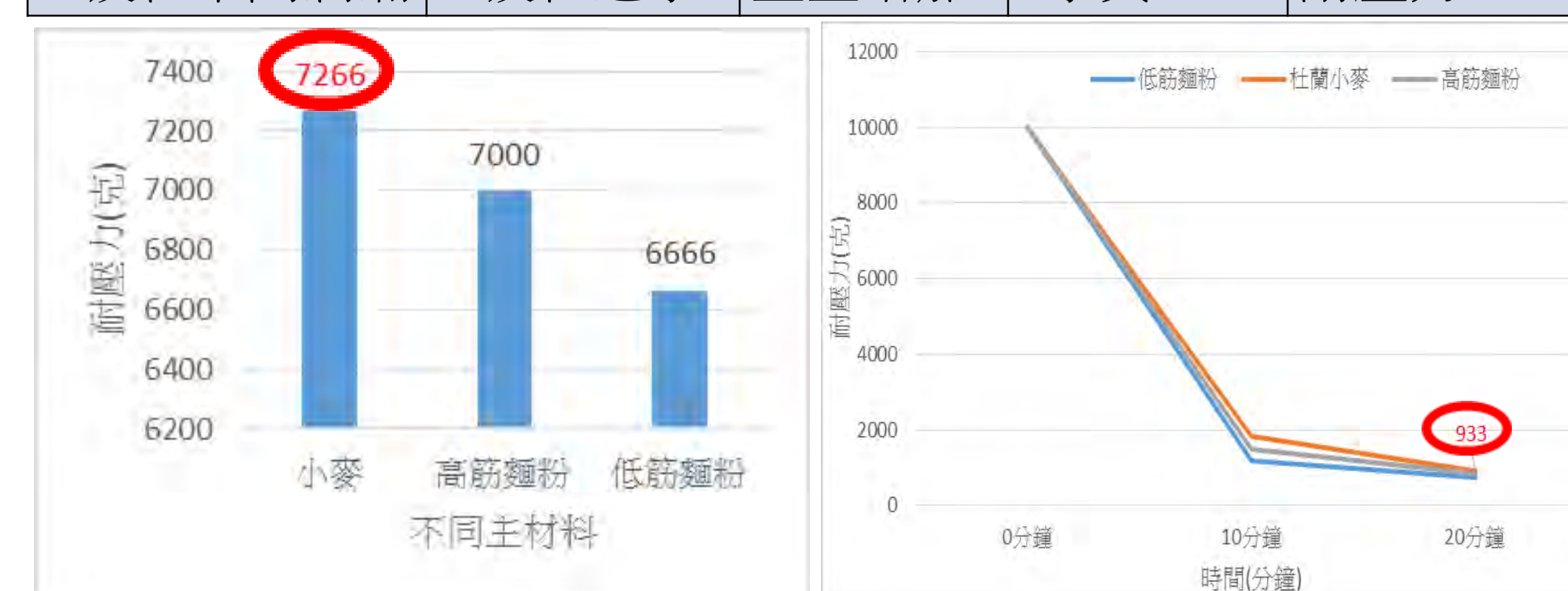
圖5 不同主材料吸管中間耐壓力
