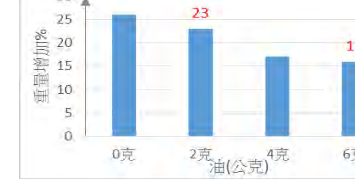
圖19 不同比例油製成吸管的重量增加
