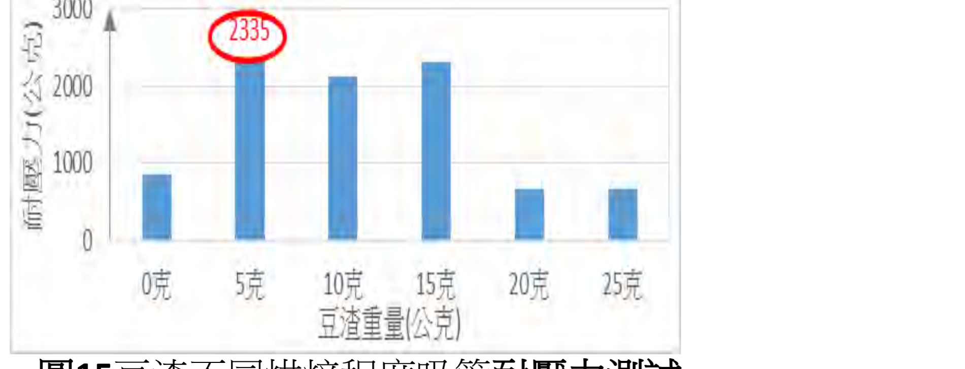
圖15 豆渣不同烘焙程度吸管耐壓力測試
