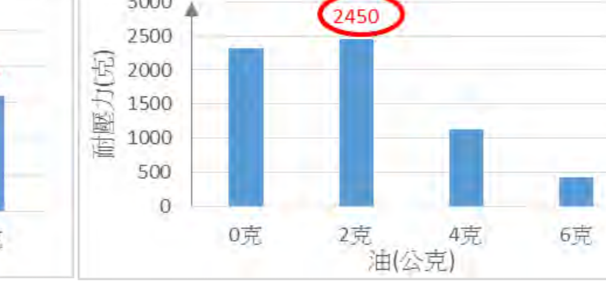
圖20 不同比例油製成吸管的耐壓力
