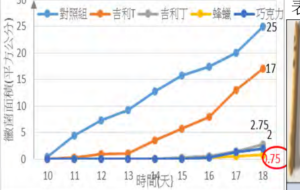
圖29 不同塗料吸管的黴菌生長面積
