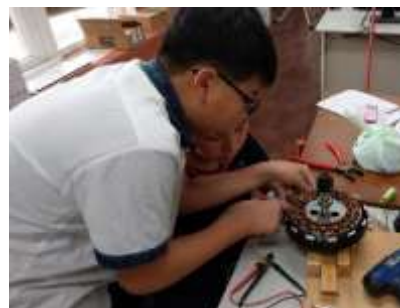
安裝 16 個磁鐵在線圈周圍
