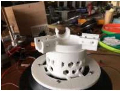
發電機基座和扇葉基座模型
