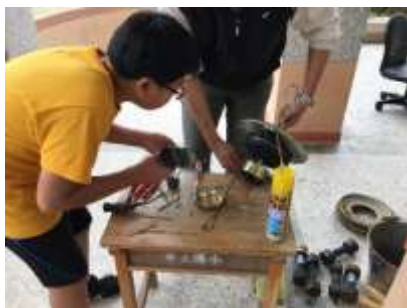
拆解廢棄電風扇取下線圈
