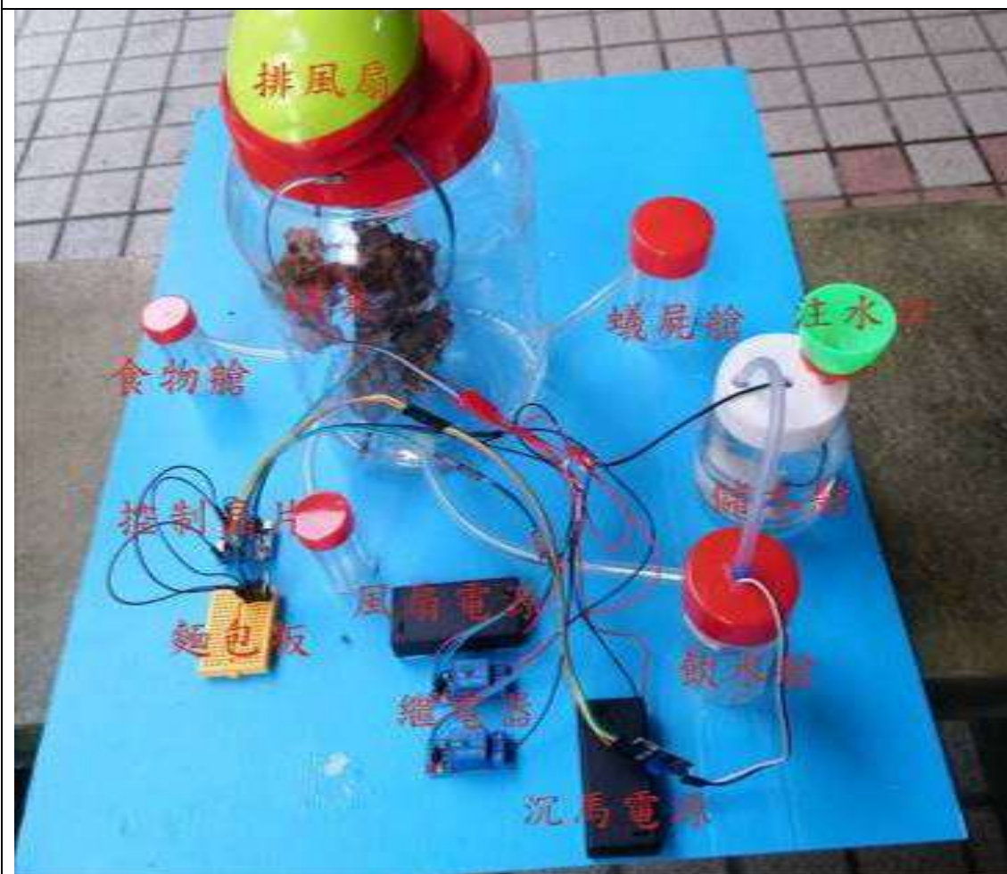
(圖 33) 具有溫濕度調節、自動補水功能的智慧型黑棘蟻觀察箱
