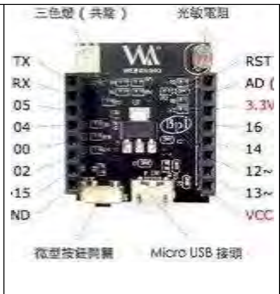
(圖 18) Webduino 就是 Web + Arduino 的合稱「透過網頁」控制物聯網的開發板
