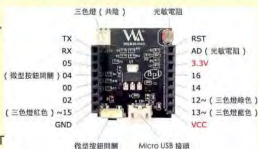
(圖19) 具物聯網功能的智能晶片 Webduino Smart 開發板
