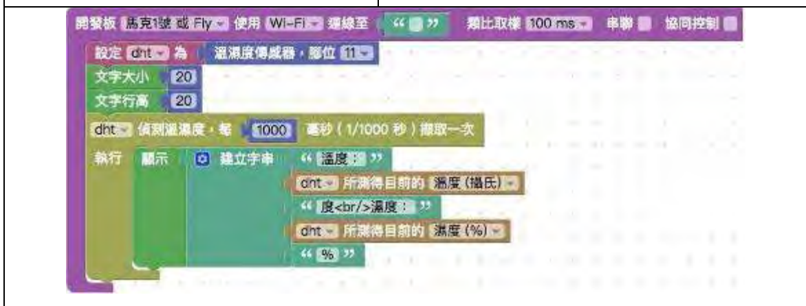
(圖 22) 積木開發程式設定每秒擷取一次溫度、濕度資料
