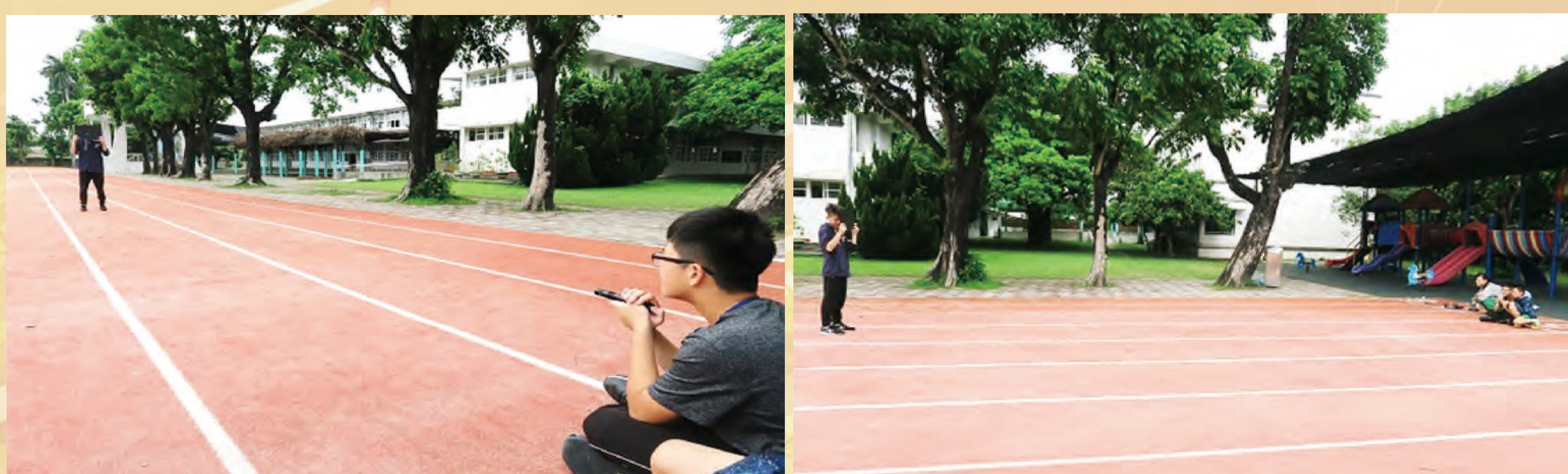
▲直接於跑道起點拿雷射筆照射一個拿著黑色紙板的同學，同學慢慢遠離，檢測最遠距離
