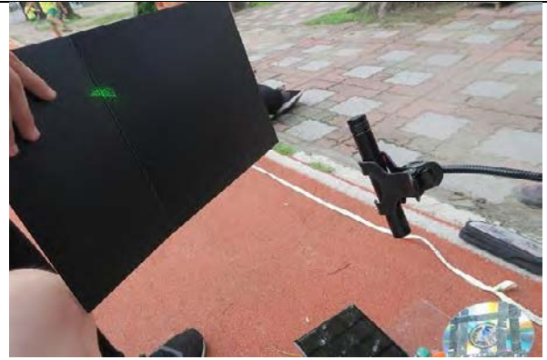
電鍍膠帶反射測試
