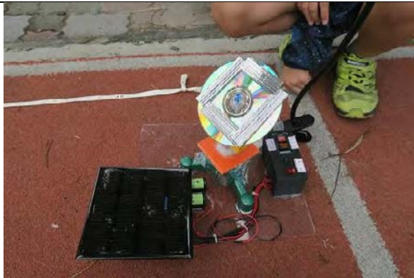
電鍍瓦楞紙反射測試
