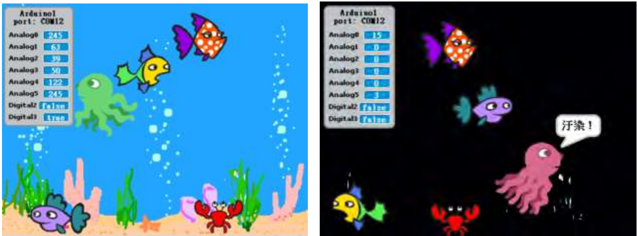
圖 40 (左)當偵測值大於臨界值，正常之多媒體畫面。(右)當偵測值小於臨界值，警告之多媒體畫面。
