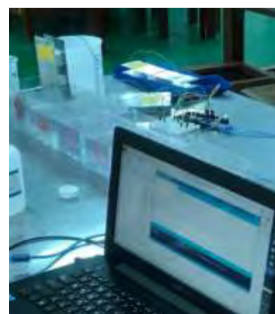
(右) 利用自製探針測水溶液 pH3~pH11 之電極電壓 A0
