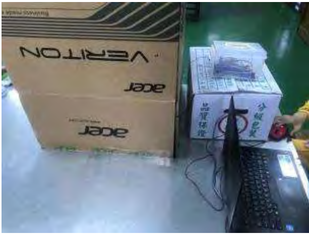
圖 21：紙箱罩住光纖、LED 與水箱，測 A0 電壓
