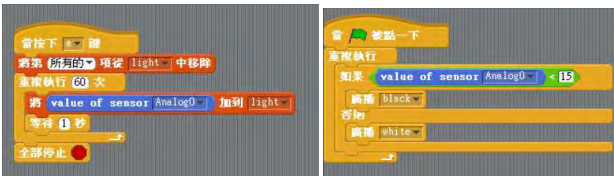
圖 38：(左)混濁度實驗程式，每一秒取樣一次，(右)當偵測值小於臨界值，發出 black 的警報。存到 light 資料庫中。
