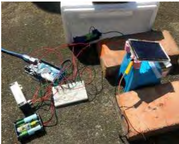
圖 1：太陽能板充電鋰電池裝置圖
