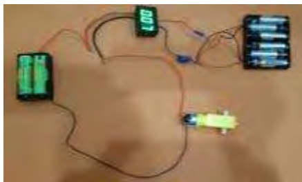
圖 5(左)：鋰電池耗電實驗裝置圖
