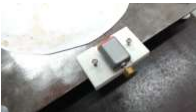
圖 3-10 將馬達黏在固定器上，並將固定器鎖在板上
