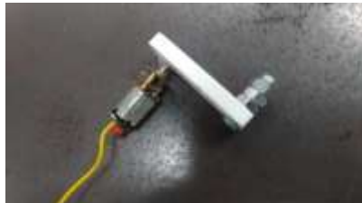
圖 3-11 繪製並列印偏心軸，固定在馬達上，加上螺帽增加重量
