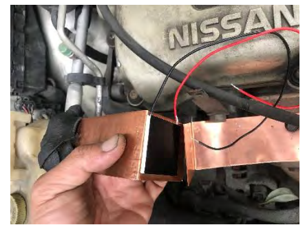
溫差晶片固定在兩片銅片重疊處
