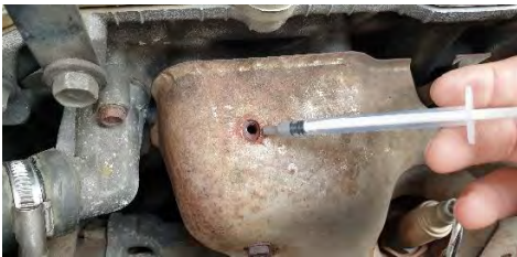
固定銅片螺絲孔也用導熱膠輔助導熱
