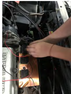
串聯連接 3 片溫差晶片
