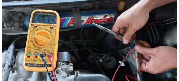
裝升壓片後電壓：1.774V
