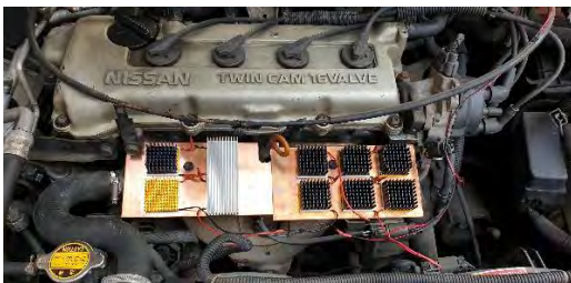
排氣管上兩個螺絲之間放置 10 片晶片固定
