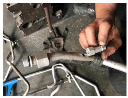
磨好的接頭黏在冷氣管上
