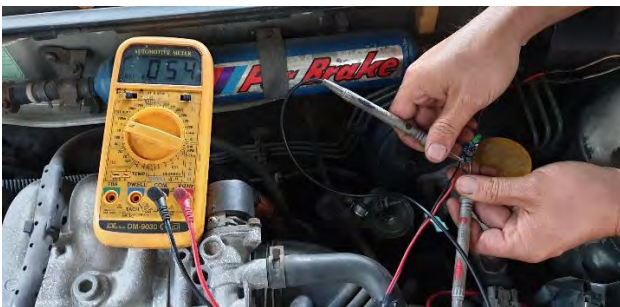
裝升壓片前電壓：0.054V
