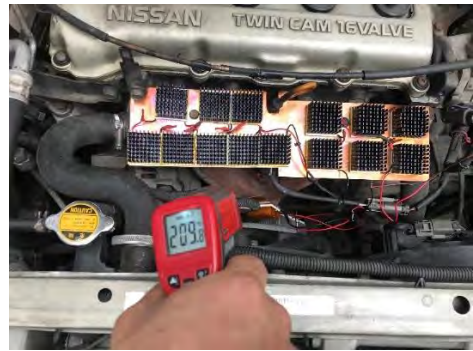
14片溫差晶片串聯 • 排氣管 209°C
