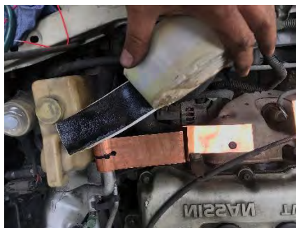
一片銅片固定排氣管 一片銅片固定5分冷氣管
