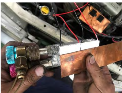
熱端用銅片導熱及固定
