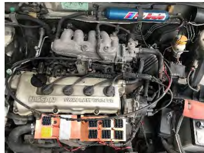
安裝引擎室內串接 10 片溫差晶片與升壓晶片 2
