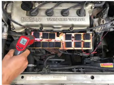
14片溫差晶片串聯 • 銅片 90.3°C
