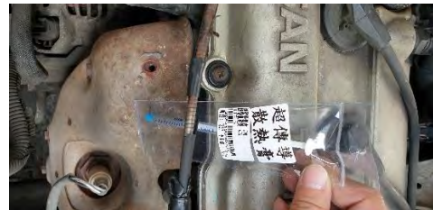
固定銅片螺絲孔也用導熱膠輔助導熱
