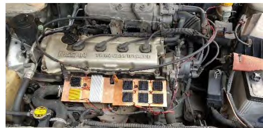
排氣管上兩個螺絲之間放置 10 片晶片固定
