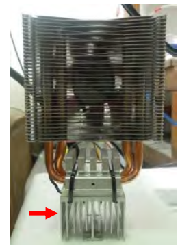
散熱片直接接觸水面
