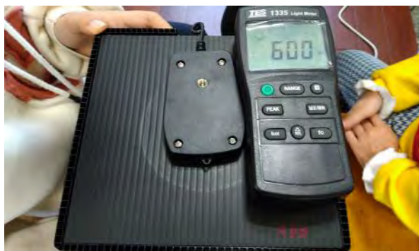
圖 4-3-3 以偏光片夾角調出 600lx 照度
