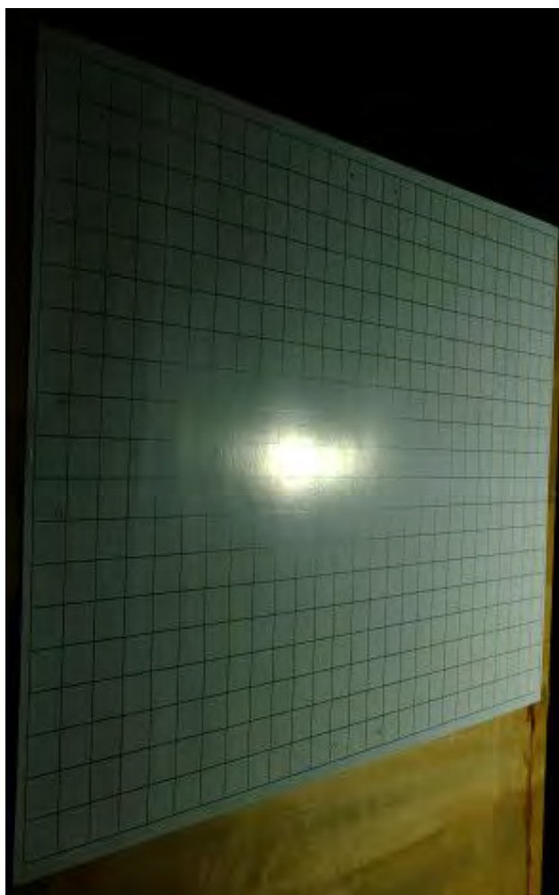
圖 5-11-3 未加防眩光燈罩時雪銅紙的眩光（垂直）
