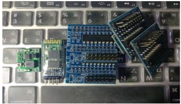
<圖>電源模組、藍芽模組、控制與驅動模組
