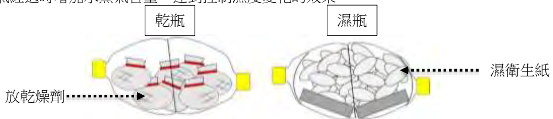
[圖 8] 乾瓶與濕瓶示意圖 (作者自行繪製)
