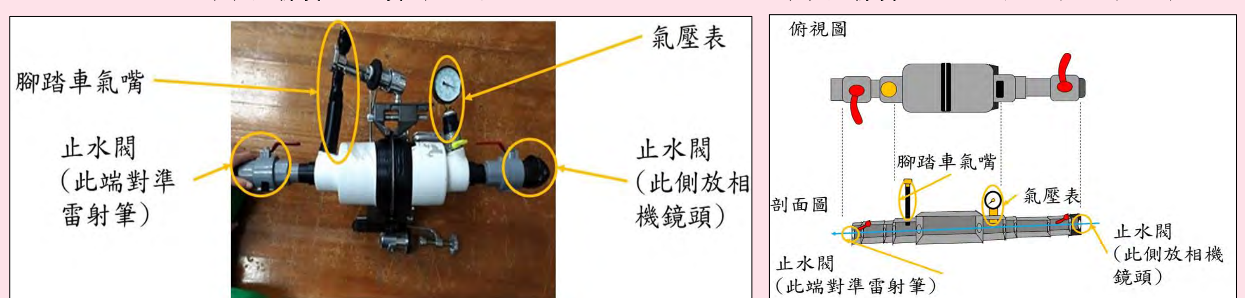
[圖7 a.b.c] 模擬不同雲霧濃度對觀測星星亮度影響之實驗示意圖(作者自行繪製)
