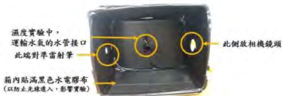
[圖 4] 自製的暗箱實際照片及實驗擺設俯視圖(作者自行繪製)
