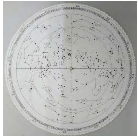
下盤包括外環的日期圈(逆時針方向)，及以天南極為中心的圓形星圖
