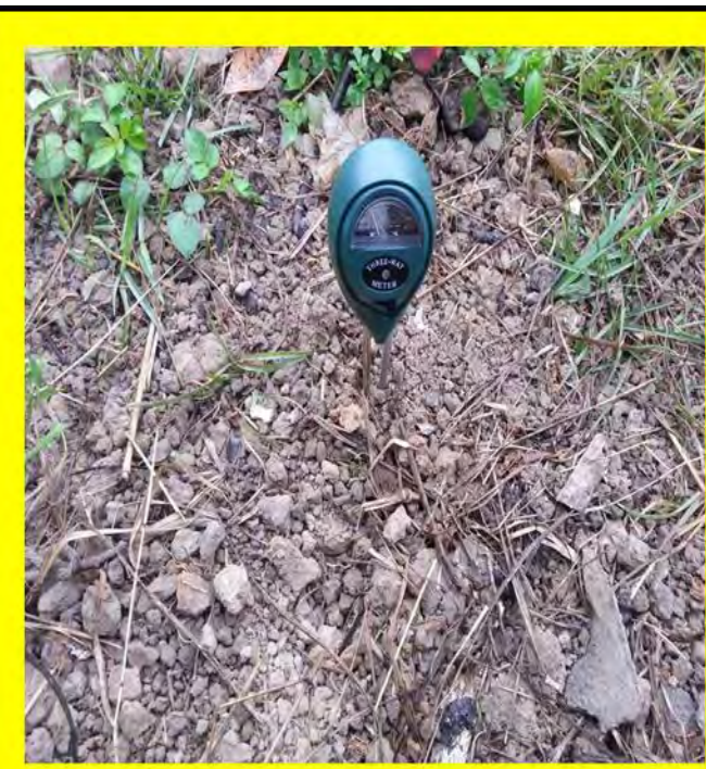
測試器垂直插入土中操作。
