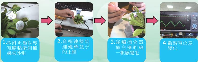
▲圖3-2 PC Based USB示波器實驗流程圖
