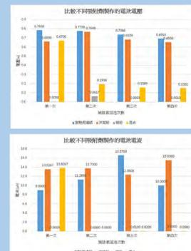
實驗結果：我們發現使用洋菜粉當做吸附劑，製作出來的電池在電壓和電流的效能最好，因此我們使用洋菜粉進行後續實驗。
