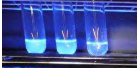
圖 2-20：左到右依序為結晶 K、乾枯瓶口、瓶身在紫外光燈下的情形
