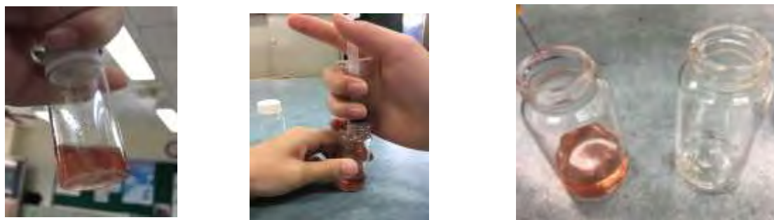
圖 2-12：(左)底部有白色顆粒、(中)透過針筒分離、(右)分離萃液與底部白色顆粒
