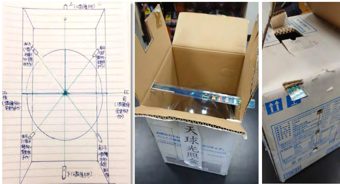
圖4-6-8 自製有天球光照盒：手繪全球設計圖與實際天球光照盒
