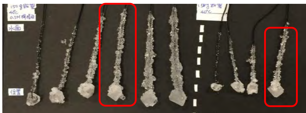
圖5-4-3 結晶從90到120分鐘後開始大量結晶，晶種下半部出現錐形(紅框標示處)
