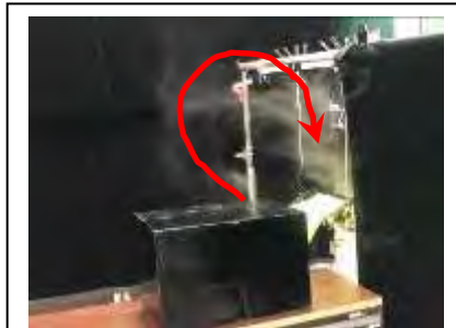
圖 8-14：左翼翼尖後方煙霧順時針方向流動。
