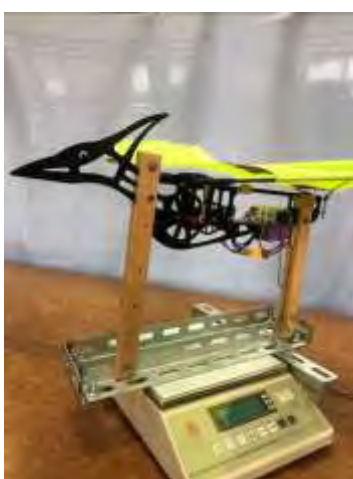
圖 5-1：將撲翅機以木條、螺絲固定於角鐵，再將其立於電子秤上。
