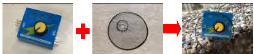
圖 3-2：在「馬達電子調速器測試儀」上套入有做6個等距的不同速度刻度記號的透明圓片。
