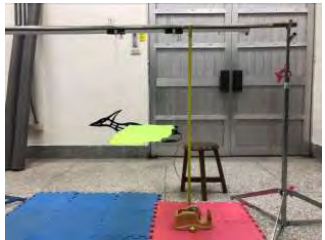
圖 3-1：在「冂」型支架木棍上及鋁架側邊布置布尺，以便後續的數據判讀。
