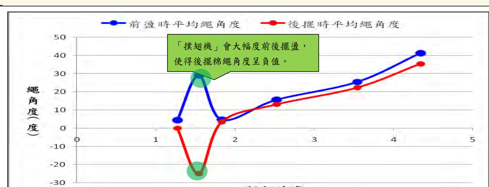
圖3-4：撲翅機在不同速度刻度下與其前盪後擺時棉繩角度之關係圖
