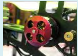
圖 2-5：選用散熱佳、重量輕、馬力大的遙控直升機專用之 KV3800 型號高速馬達。
