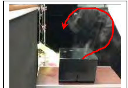
圖 8-15：右翼翼尖後方煙霧逆時針方向流動。
