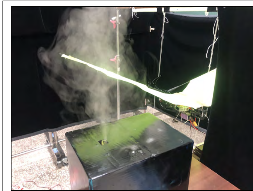
圖 8-1：將自製「煙霧製造機」置於撲翅機左翼及右翼「翼尖後方」。
