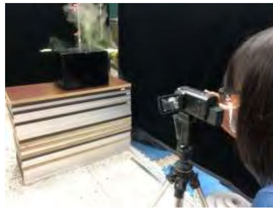
圖 8-2：器材後 1.5m 處以水平視角架設攝影機以進行後續分析。
