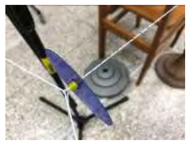
圖 6-7：將「氣流流向檢測儀」主體套在畫有尺規刻度的棉繩上。
