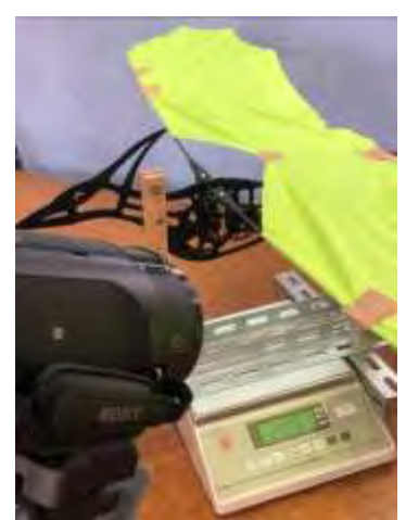
圖 5-2：在器材左前方約 1m 處架設一台攝影機，錄製撲翅機振翅過程中電子秤上數值。
