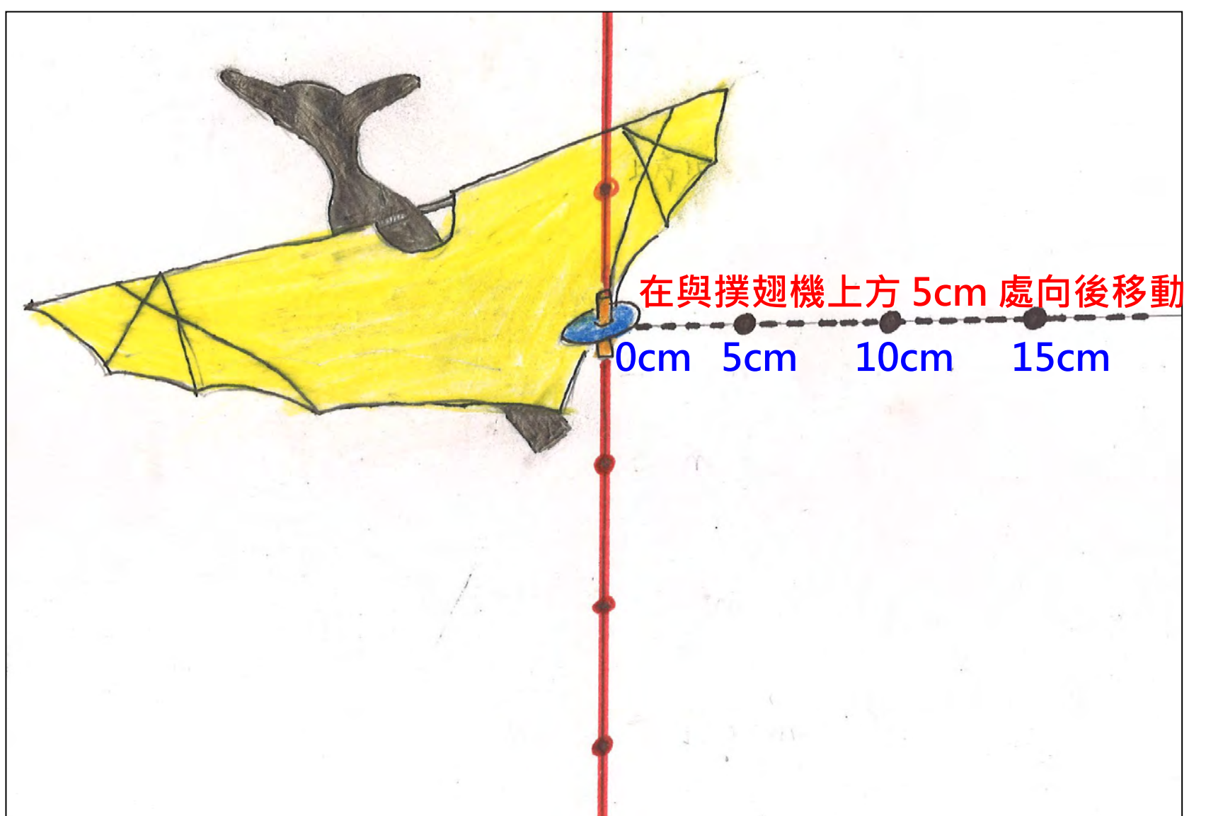
圖 6-7：將「氣流流向檢測儀」垂直架設於 A~E 區，分別調整其位置為撲翅機後方 0cm 處、後方 5cm 處、後方 10cm、後方 15cm 處(圖中以 E 區為例，以撲翅機上方 5cm 處再向後方調整)
