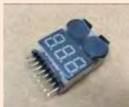
圖 2-8：和鋰電池連接，自動檢測鋰電池每個電芯的電壓和總電壓，當電壓低於設定值時，蜂鳴器會響起，紅色 LED 閃爍，可避免鋰電池因過度放電而造成損壞。
