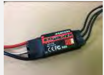
圖 2-6：一端連接高速馬達，另一端連接馬達電子調速器測試儀及鋰電池組，功能是接收馬達電子調速器測試儀的信號，根據此信號調節馬達的轉速，影響撲翅機的翅膀振動速度。
