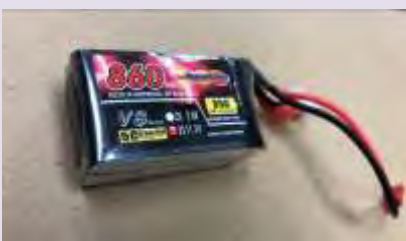
圖 2-9：和電子調速器連接，3S 電池組是代表這塊電池裡有三小個鋰電池，是可快速充電且循環壽命長，在高溫環境下穩定性高的遙控飛機專用之鋰電池組。
