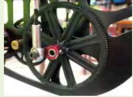
圖 2-4：使用齒輪組合，帶動高速馬達，使撲翅機雙翼可對稱性振動。
