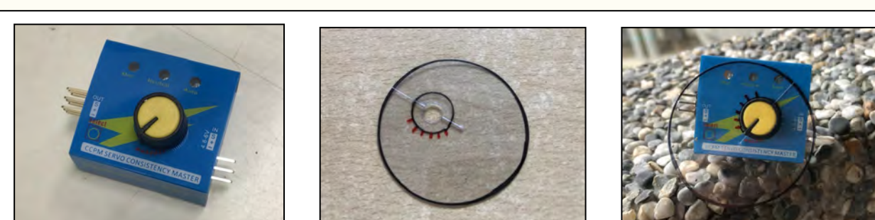
圖3-2：在「馬達電子調速器測試儀」上套入有做6個等距的不同速度刻度記號的透明圓片。
