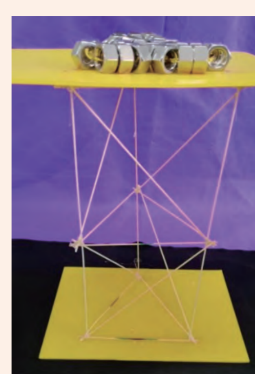
膠帶加強直立柱中間點進行實驗
