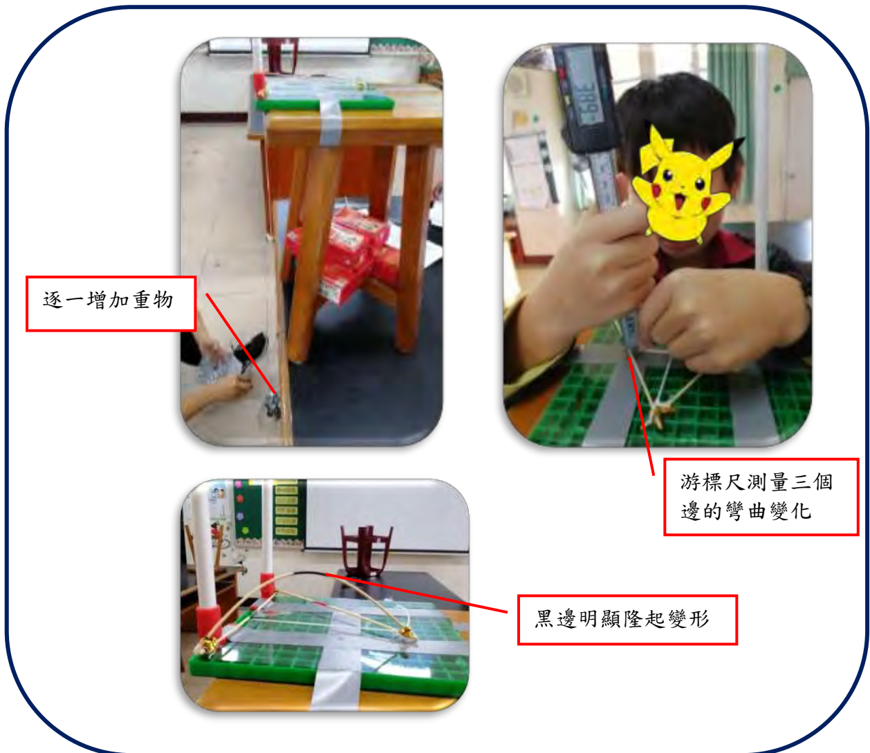
圖六 利用剪力測量儀器，測試剪力與邊的彎曲變化
