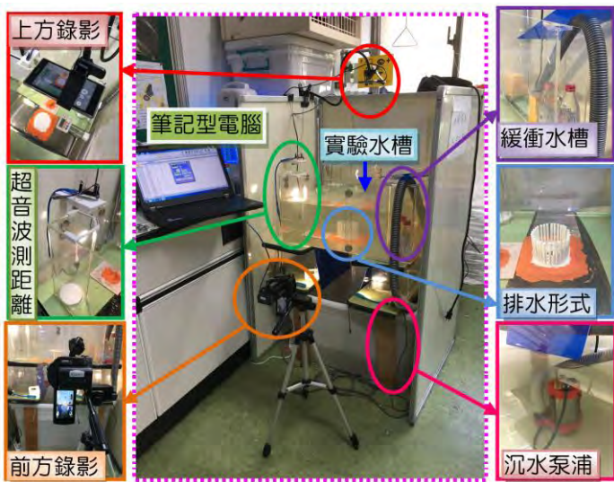
圖 1. 落水頭排水口圖示 圖 2. 積水水位高度離排水口距離示意圖 圖 3. 排水實驗裝置
