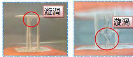
圖 15. 增加上蓋時漩渦的產生與變化情形
