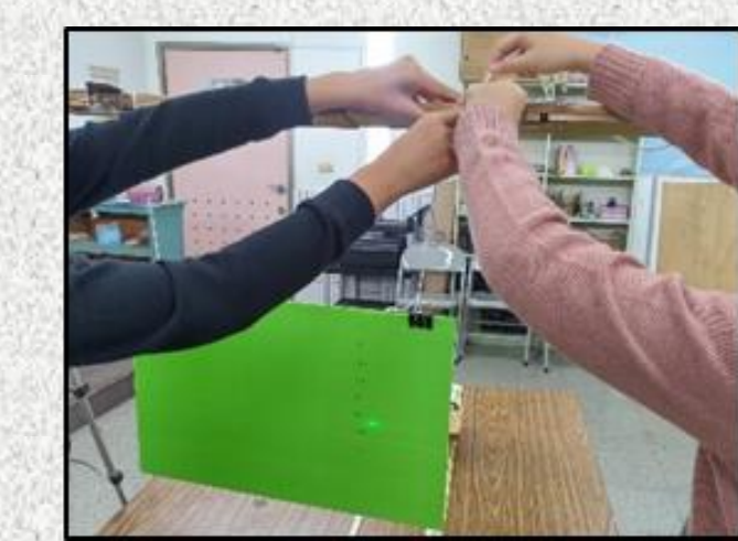
利用雷射筆確認PP板的高度
