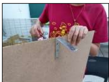
圖 6-13 木板後方鎖上 L 型鐵架
