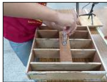
圖 6-16 將木板組裝成一個方框 圖 6-17 在這四片方框中的木板 鎖上門片鉸鍊 圖 6-18 在連動木板裝上把手
