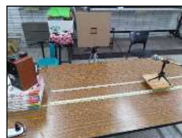
圖 6-15 藉著雷射筆光線路 徑確認反射板位置及角度
