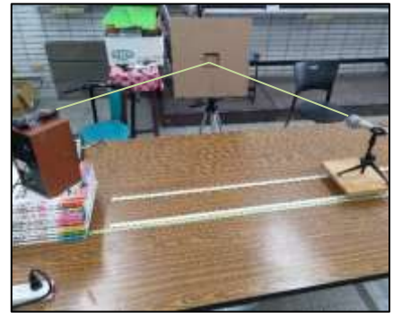
雷射筆確認反射板角度示意圖
