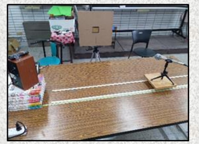
雷射筆光線路徑確認反射板位置角度
