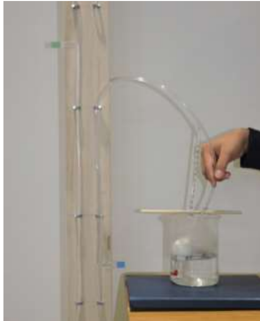
以自製的壓力計測量加熱乒乓球內的氣體壓力。
