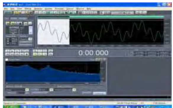
圖 10 C4 和 C6 和音所組成的複合波形
