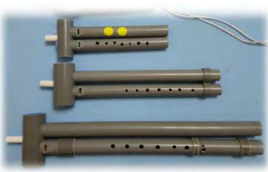
圖 21 利用各種膠管製成複管笛進行實驗
