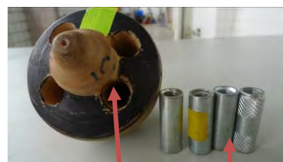
圖 10 挖孔 配重 25 克 陀螺尾部用電鑽挖出四個洞
