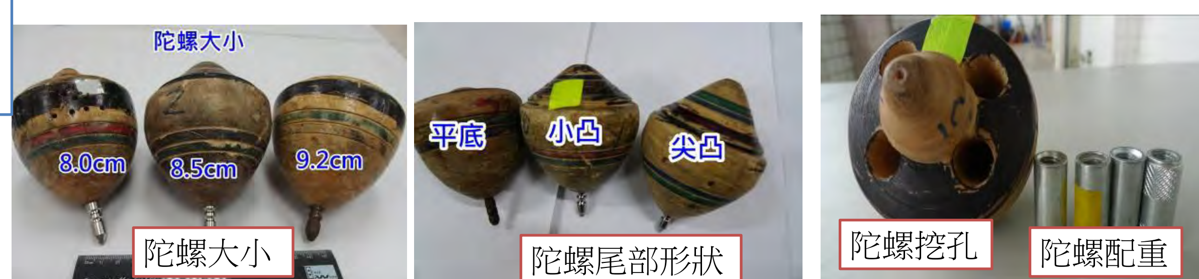
圖3-3 陀螺重量對轉速、轉動時間的影響
