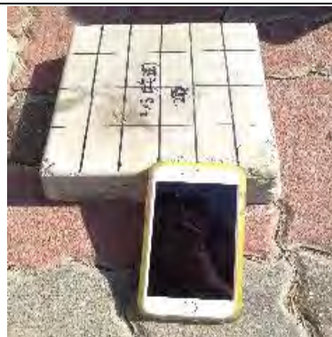
圖中用手機計時器測試水滴乾燥所需的時間。
