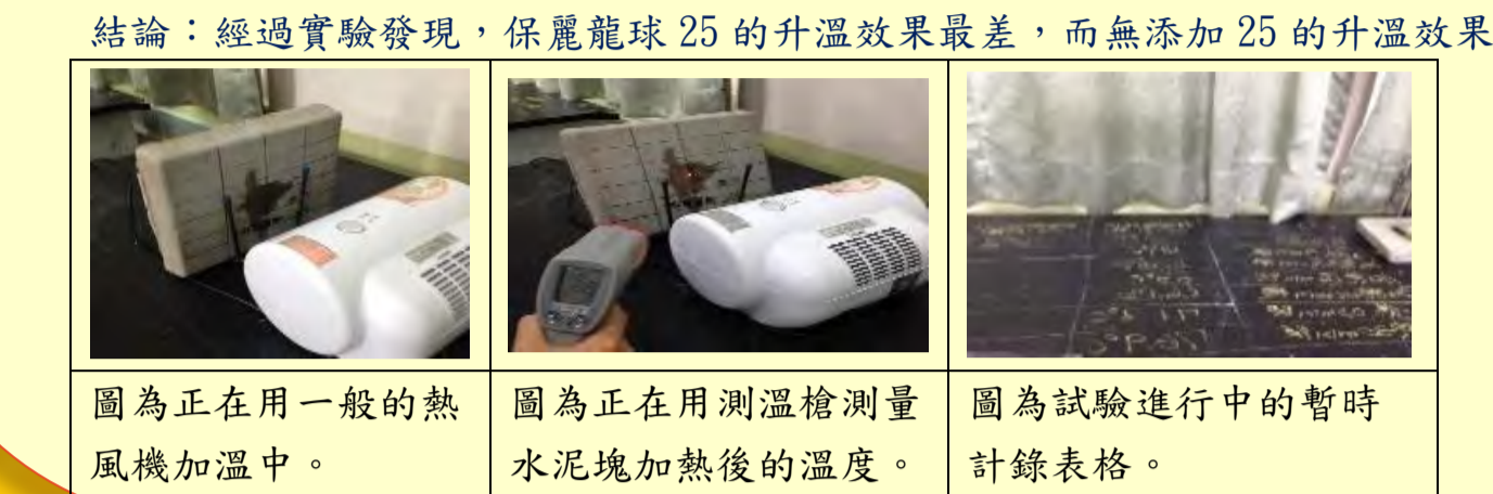
圖為正在用一般的熱風機加溫中。圖為正在用測溫槍測量水泥塊加熱後的溫度。圖為試驗進行中的暫時記錄表格。
