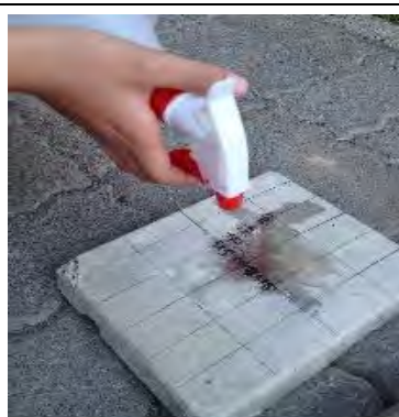
圖中用噴水器分別在水泥塊正中央噴水 10 滴。
