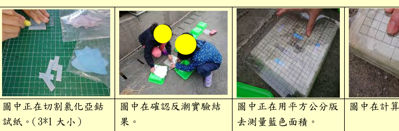
圖中正在切割氯化亞鈷試紙。(3*1大小) 圖中在確認反潮實驗結果。圖中正在用平方公分版去測量藍色面積。圖中在計算變色面積。
