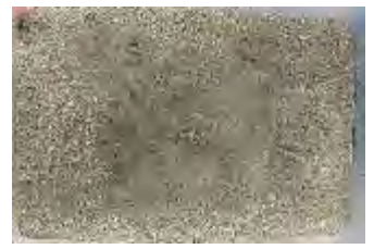
圖 23：間距 2cm 有 91 個洞，平均有 13.4 個沙泡。產生沙泡率較高。
