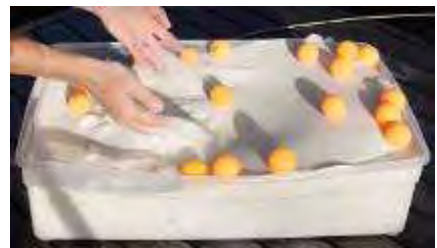
圖 3：影片中，乒乓球會漂浮在流體化床沙箱中。
