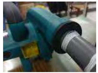
圖 4：到水族賣場購買魚缸打氣機，但氣太弱。 圖 5：套上氣球皮嘗試連接水管，但漏氣失敗。 圖 6：塞入多根水管能夠噴氣，但不實用。 圖 7：1 吋的水桶接頭剛好能塞入電動鼓風機，再連接 PVC 水管。
