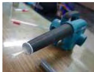
圖 4：到水族賣場購買魚缸打氣機，但氣太弱。 圖 5：套上氣球皮嘗試連接水管，但漏氣失敗。 圖 6：塞入多根水管能夠噴氣，但不實用。 圖 7：1 吋的水桶接頭剛好能塞入電動鼓風機，再連接 PVC 水管。
