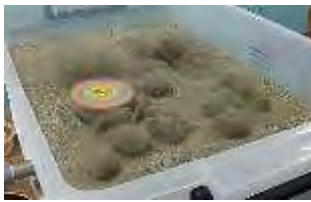
圖 13: 沙泡高度過高，會減少陀螺轉動時間。
