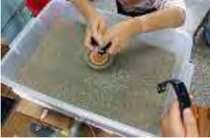
圖 12: 用陀螺轉動時間測量旋轉摩擦力大小。
