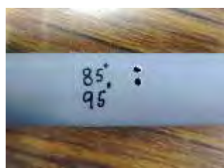
圖 17：90 度要打兩個洞，改成用 85、95 度
