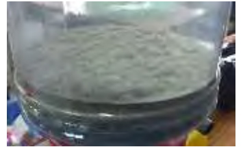
圖 43：因均勻噴氣，沙量低時產生密集小沙泡
