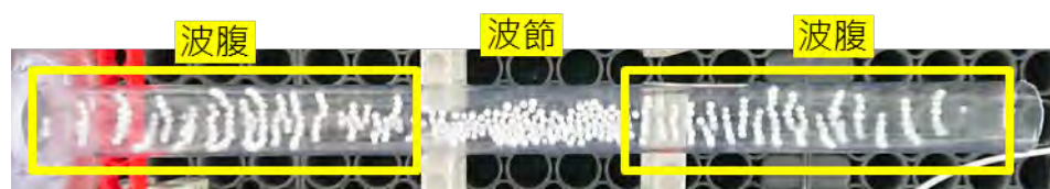
圖 6：開口管產生駐波時，發泡球振動情形
