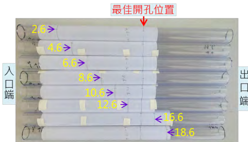
圖 20：標示雙位置開孔的穿孔管
