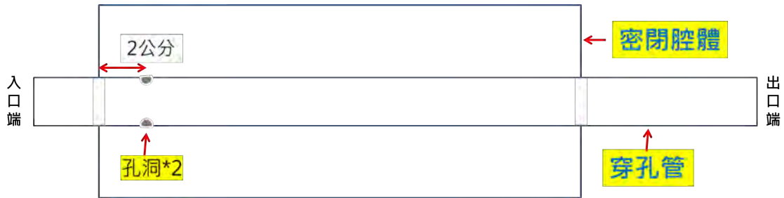
圖 8：孔洞在 2 公分位置示意圖
