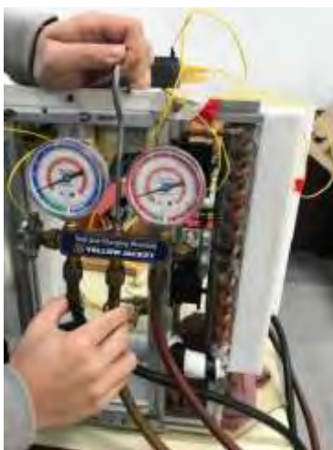
圖 40.冷媒量最佳化測試
