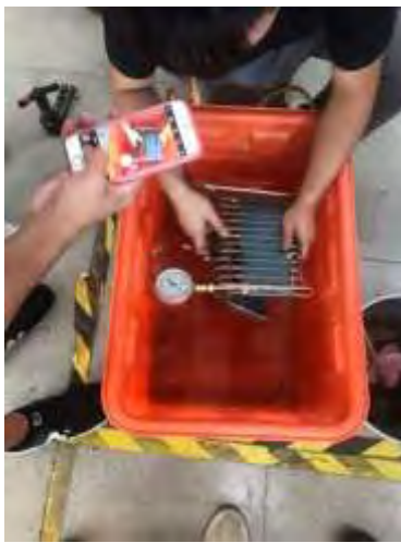
圖 14. 焊接好的蒸發器水中探漏
