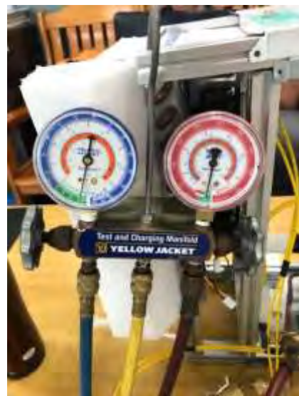
圖 37.系統站空 看壓力表維持真空狀態
