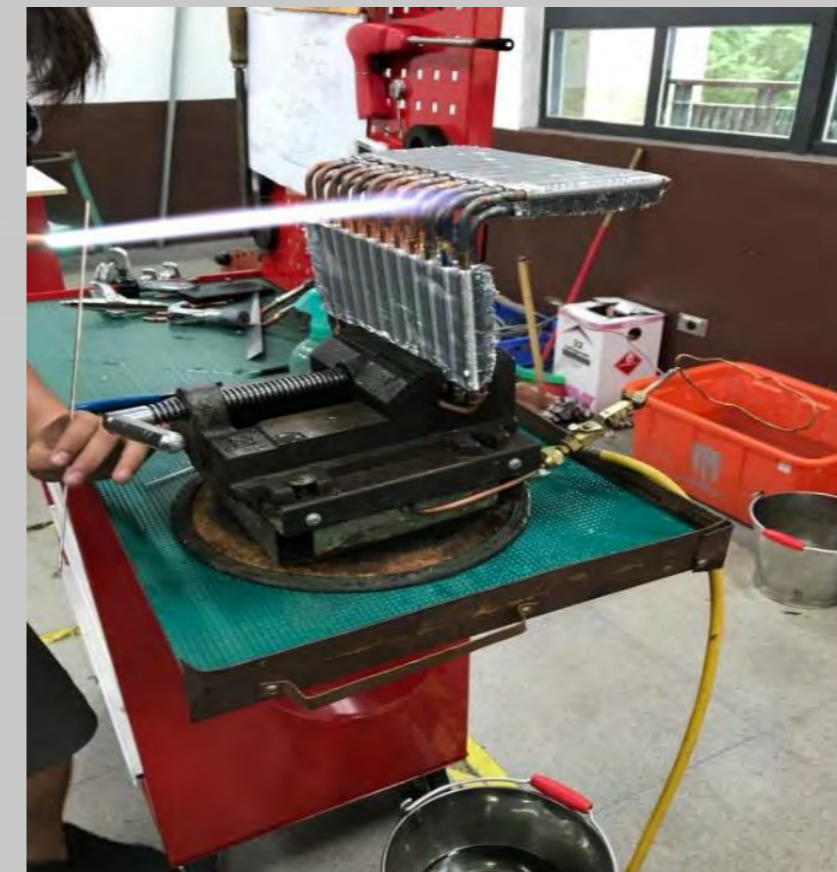
焊接L型冷凝器
