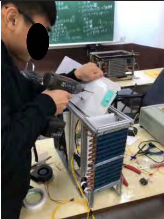
圖 34.鑽孔安裝開關
