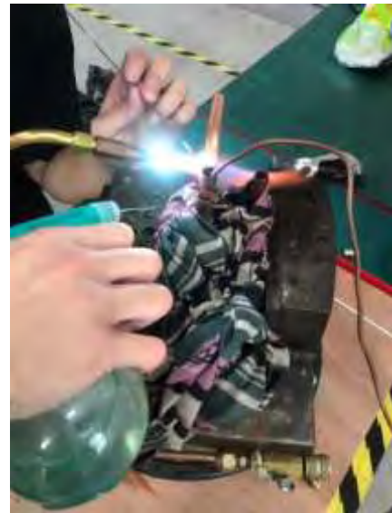
圖 17. 製作毛細管銲接
