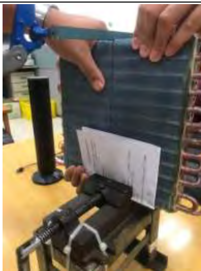
圖 10.切割改造冷凝器及蒸發器
