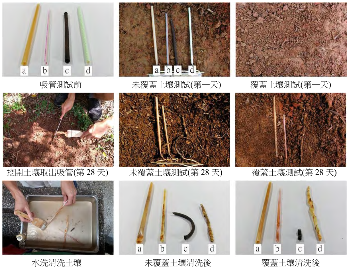
圖 30. 紅茶吸管腐敗性之變化情形 (a 甘蔗吸管、b 塑膠吸管、c 紅茶吸管、d 紙吸管)
