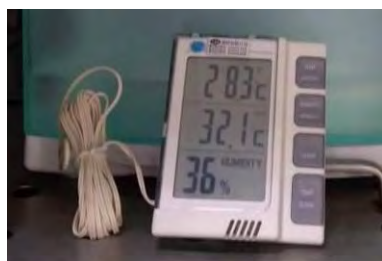
A. 24 小時後測量乾燥箱內之相對濕度 B.貯藏 1 週後測量空氣中之相對濕度
