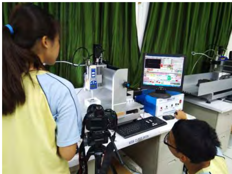
利用 CNC 和推拉力計，測試新型吸管的硬度
