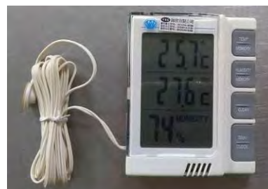
A. 24 小時後測量乾燥箱內之相對濕度 B.貯藏 1 週後測量空氣中之相對濕度
