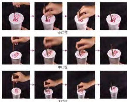
圖23. 不同口徑「紅茶吸管」手搖杯飲品封口膜戳入測試
