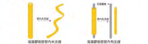
圖10. 「第二代海藻膠吸管」、「第三代海藻膠吸管」製作之比較
