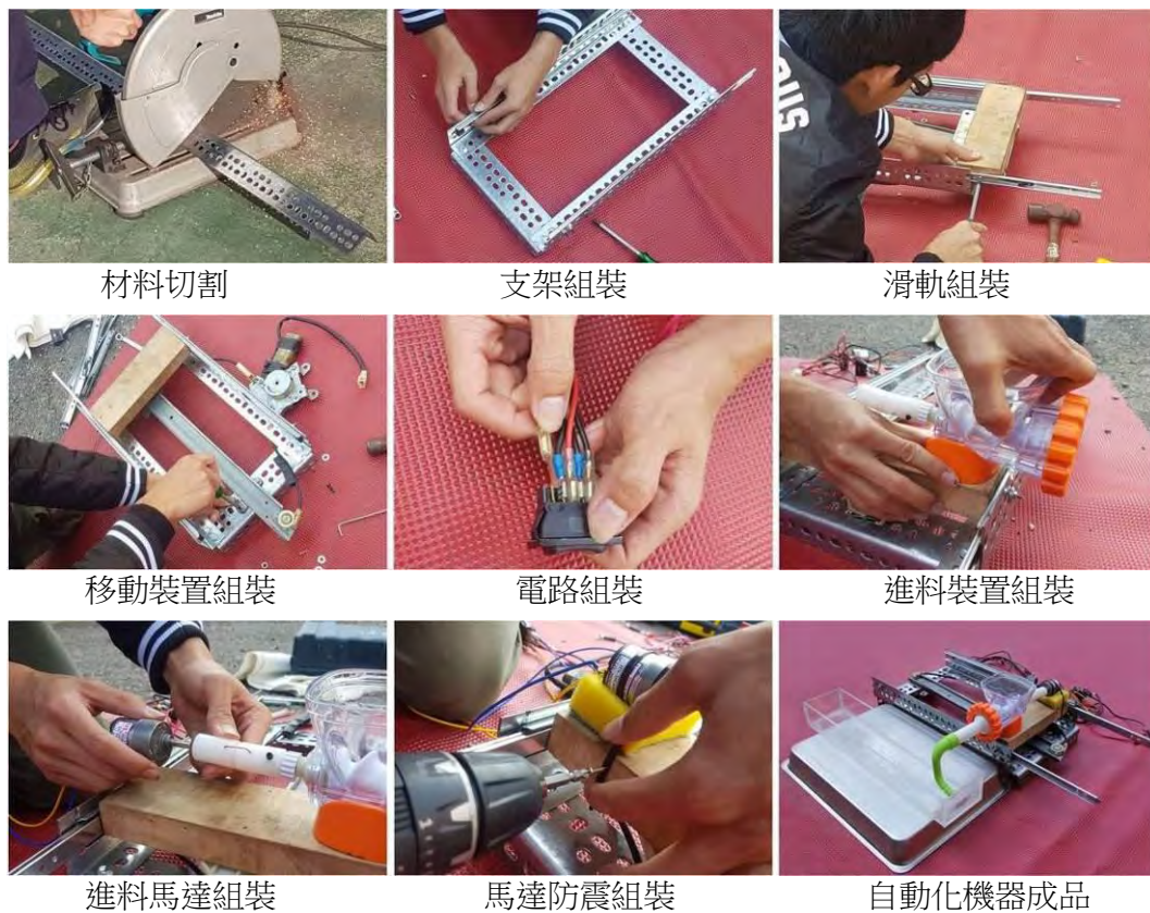
圖 31. 擠出成型機械製作組裝之過程
