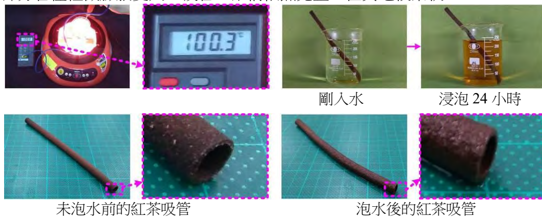
圖 26. 「紅茶吸管」之耐高溫測試
