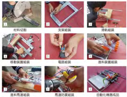
圖30. 擠出成型機械製作組裝的過程
