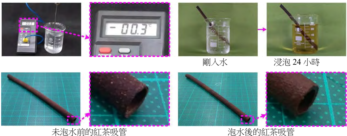
圖 25. 「紅茶吸管」之耐低溫測試
