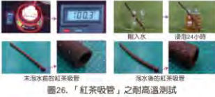
圖26. 「紅茶吸管」之耐高溫測試
