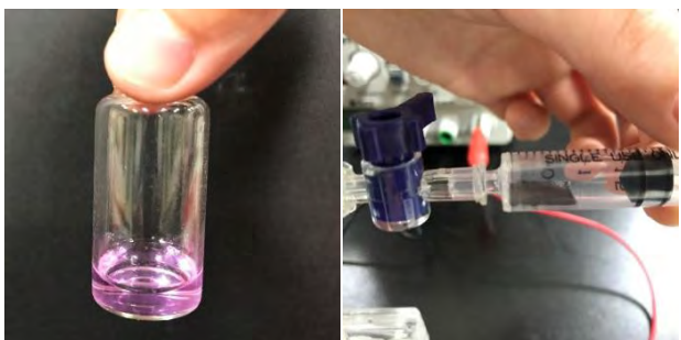
圖12：圖左、右為NaOH與Cl 2 的檢驗
