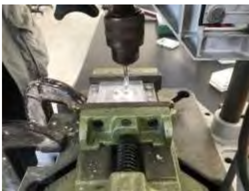
圖 5：圖左為攻牙電鑽與支撐架，圖右為螺絲攻牙過程
