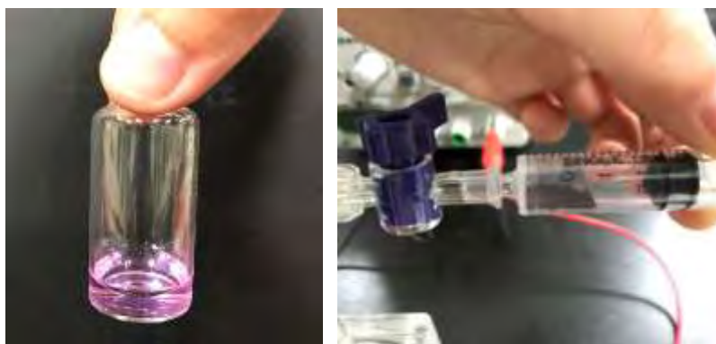
圖 15：圖左為陰極水溶液酸鹼性檢測，圖右氯氣的檢驗
