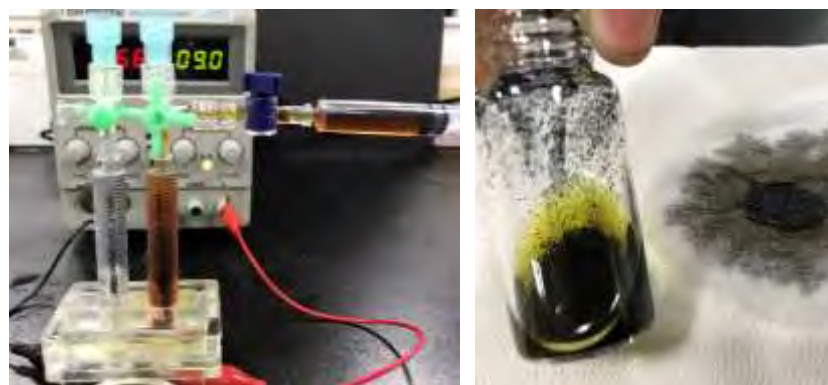
圖 16：圖左為正極產物的收集，圖右為碘的檢測
