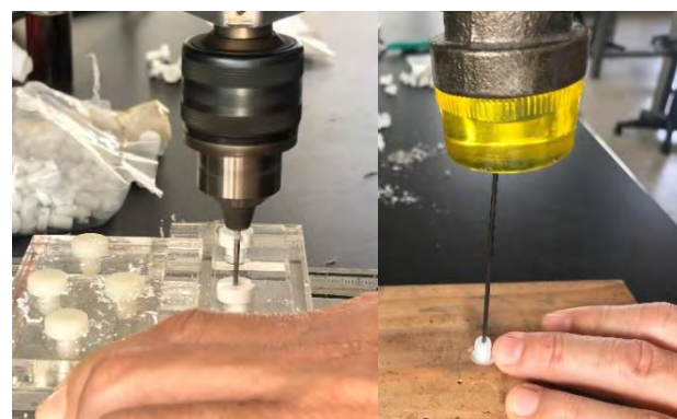
圖9：圖左螺絲鑽孔，圖右為電極安裝
