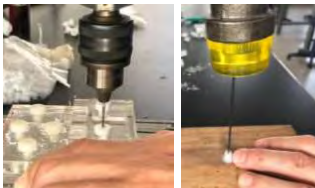
圖 6：圖左螺絲鑽孔，圖中為螺絲安裝貫穿電極
