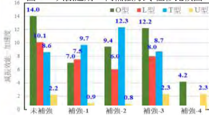
圖 6-3 共振週期 X 向補強方式-加速度比較圖
