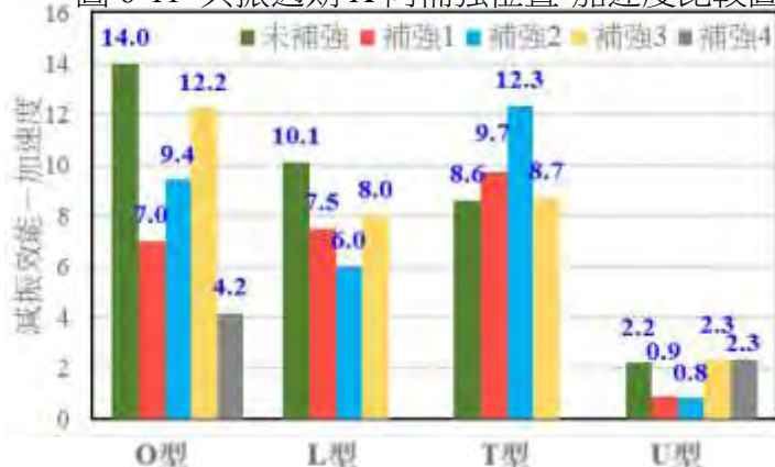
圖 6-12 共振週期 Y 向補強位置-加速度比較圖
