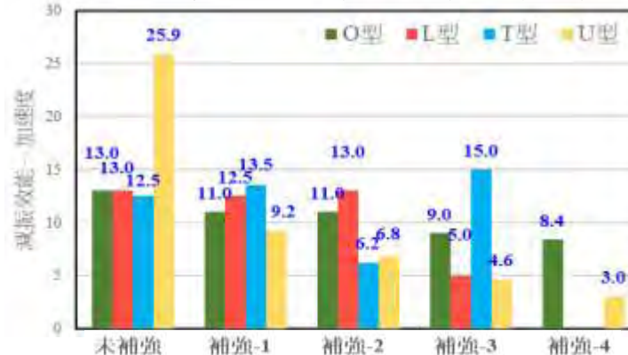
圖 6-4 共振週期 Y 向補強方式-加速度比較圖
