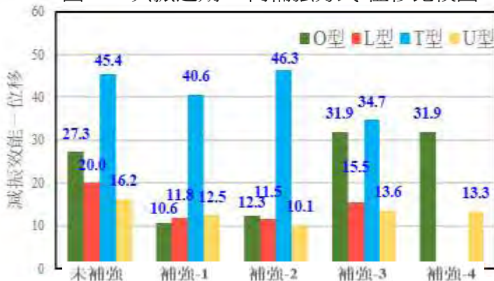
圖 6-2 共振週期 Y 向補強方式-位移比較圖
