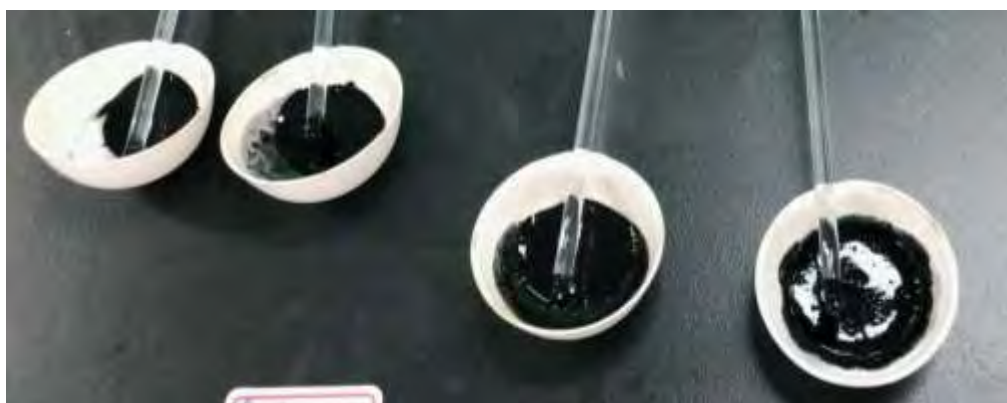
圖3 加入石墨於膠水的情形
