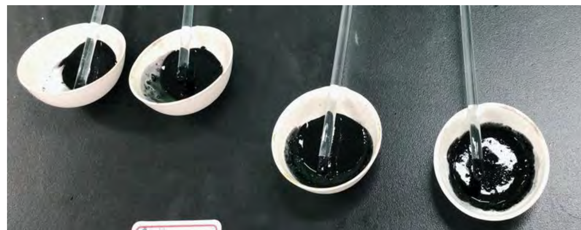
圖四 加入石墨於膠水的情形
