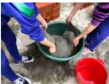
圖 4-48 將低鹼卜特蘭水泥倒入砂盆中
