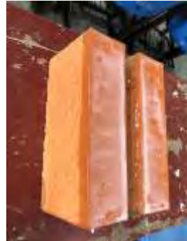
圖 4-8 浸泡 1:13 撥水劑的磚表面
