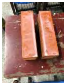
圖 4-7 浸泡純撥水劑的磚表面
