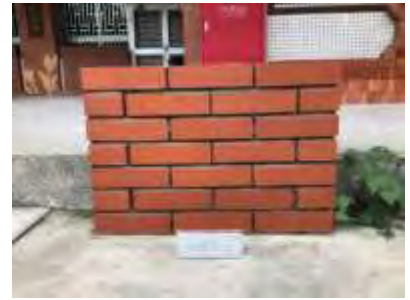
圖 4-52 低鹼水泥砂漿牆之完成品
