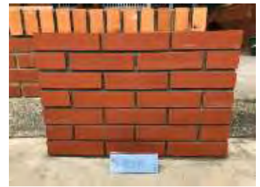
圖 4-65 撥水劑水泥砂漿牆之完成品
