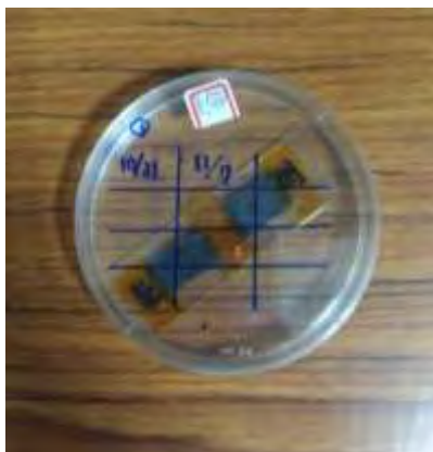
圖 4-9：水接觸角樣本。左：無側孔處理，右：開側孔處理
