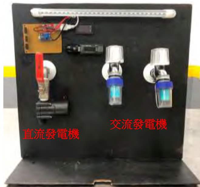
圖6 本研究創作之「小型水力發電系統」的作品完成圖。
