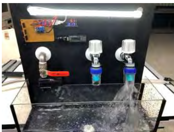
圖7 本研究創作之「小型水力發電系統」僅開啟一個交流發電機發電。(以抽水馬達測試)
