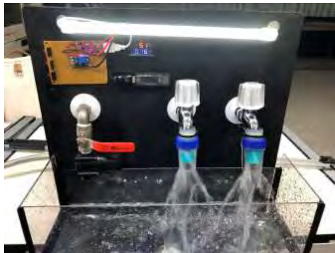
圖8 本研究創作之「小型水力發電系統」僅開啟二個交流發電機發電。(以抽水馬達測試)
