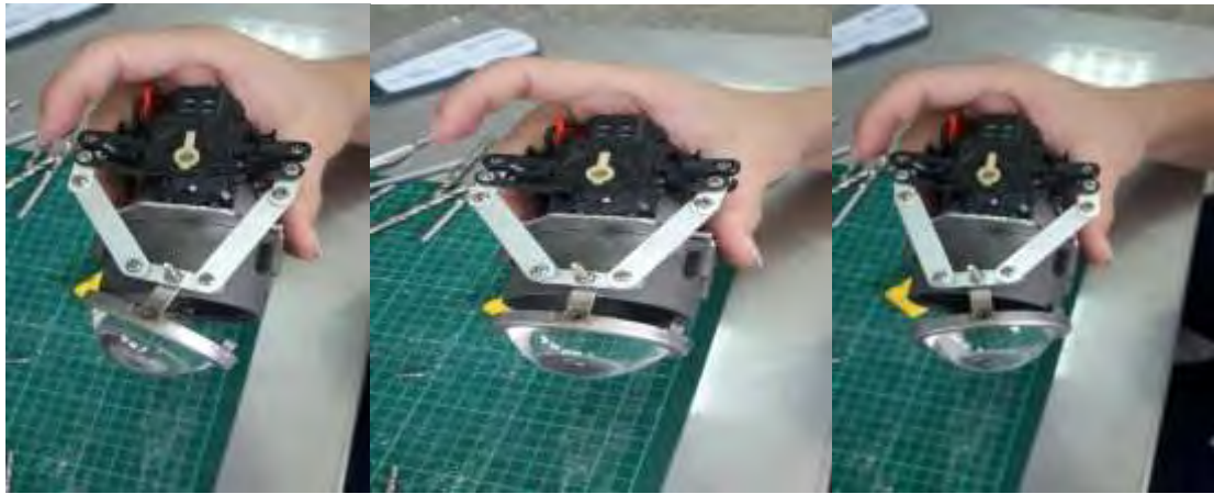
圖 4-6 頭燈連桿機構組裝測試圖 (圖 4-6 研究者拍攝)
