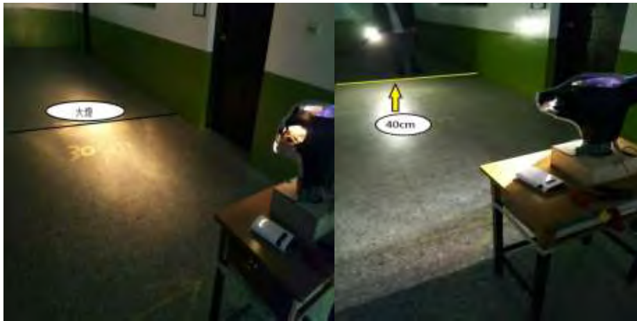
圖 4-13 大燈自動切換成防眩光燈 (圖 4-13 研究者拍攝)
