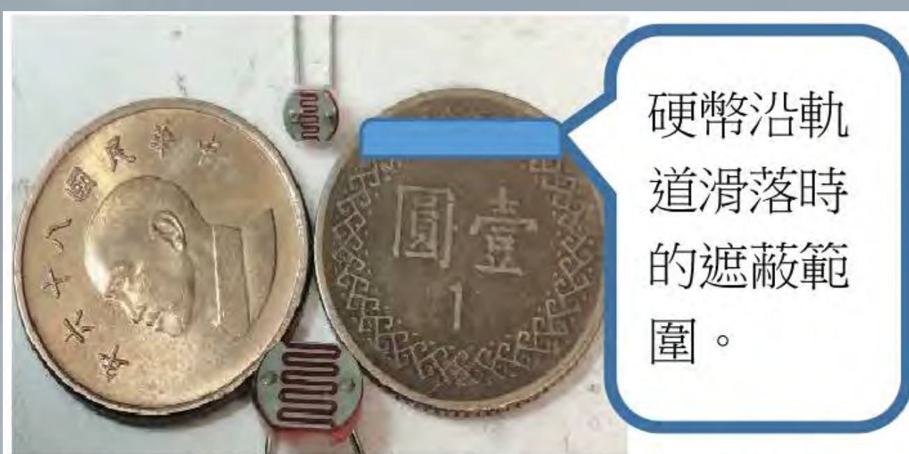
圖8 硬幣平貼滑過可完全遮蔽光敏
