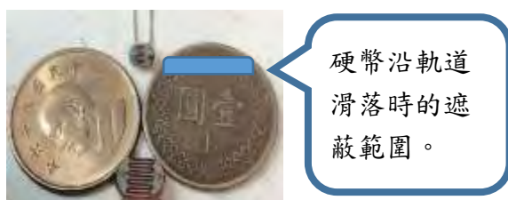
圖 24 硬幣平貼滑過可完全遮蔽光敏電阻
